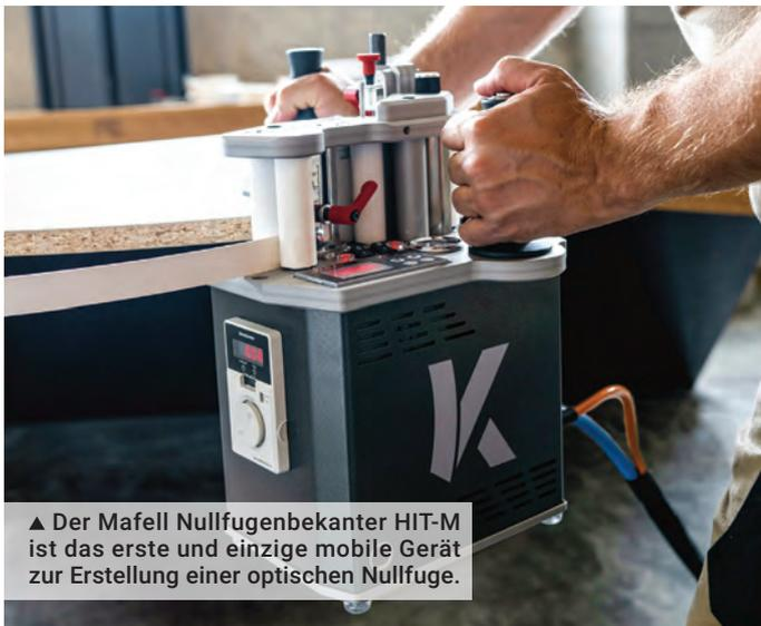
▲ Der Mafell Nullfugenbekanter HIT-M ist das erste und einzige mobile Gerät zur Erstellung einer optischen Nullfuge.
