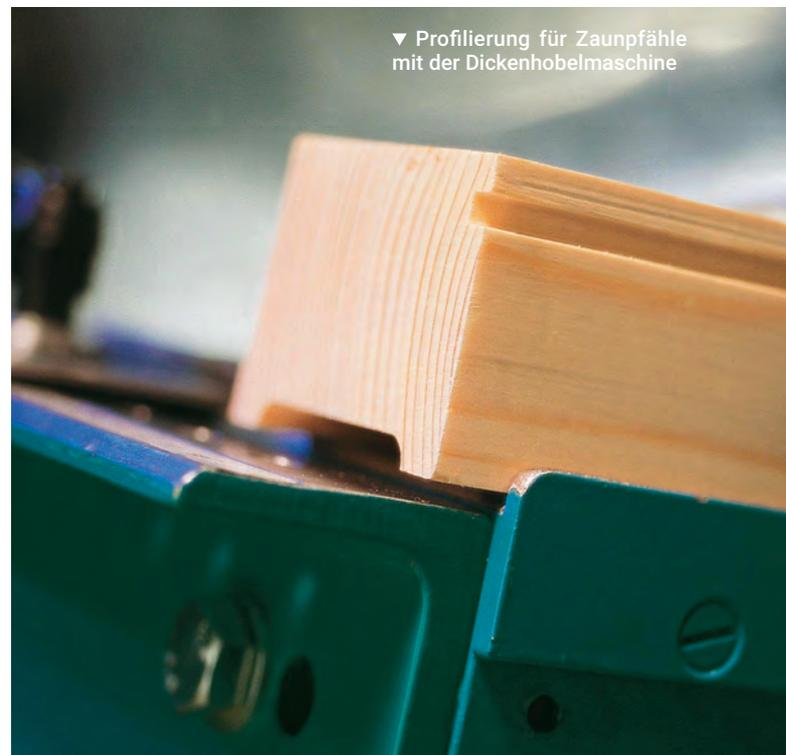
▼ Profilierung für Zaunpfähle mit der Dickenhobelmaschine
