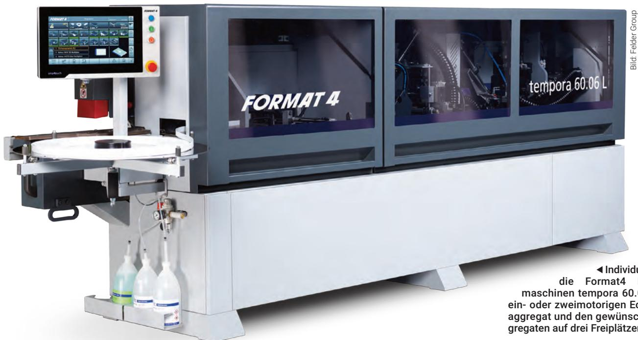
◀ Individuell lassen sich die Format4 Kantenanleimmaschinen tempora 60.06L mit einem ein- oder zweimotorigen Eckenrundungsaggregat und den gewünschten Finishaggregaten auf drei Freiplätzen ausstatten.
