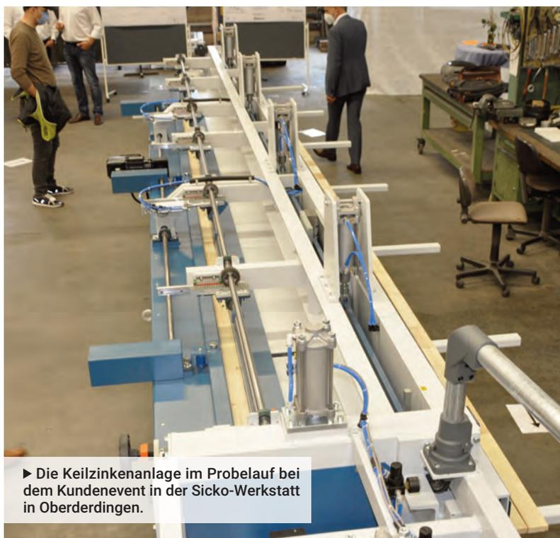
► Die Keilzinkenanlage im Probelauf bei dem Kundenevent in der Sicko-Werkstatt in Oberderdingen.
