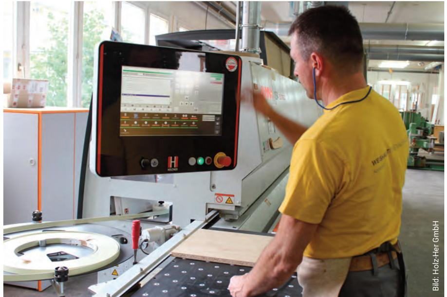
▲ Maschinist Kläus Inauen an der Steuerung der Lumina: Das große Touch-Screen-Terminal sorgt für einfache Bedienerführung.
