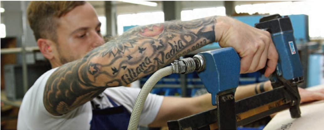
▲ Mit der BeA-Klammer Type 14 werden bei Himolla die Komponenten im Gestellbau fixiert.
