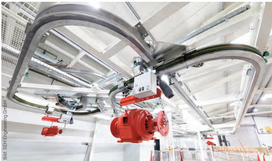
▲ Durch ihre spezielle Konstruktion sind die Aluminiumschienen zwar extrem belastbar, wiegen jedoch wesentlich weniger. Das reduziert die Kosten der Anlage. Trotzdem ist Skyrail hochstabil für Nutzlasten bis 400kg im Zweifach-Fahrzeug und bis 800kg im Vierfach-Fahrzeug ausgelegt.
