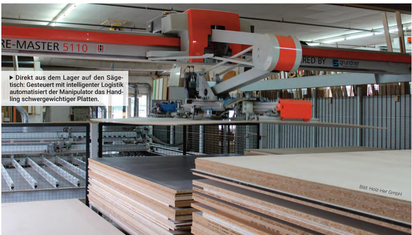
► Direkt aus dem Lager auf den Säge-tisch: Gesteuert mit intelligenter Logistik automatisiert der Manipulator das Handling schwergewichtiger Platten.
