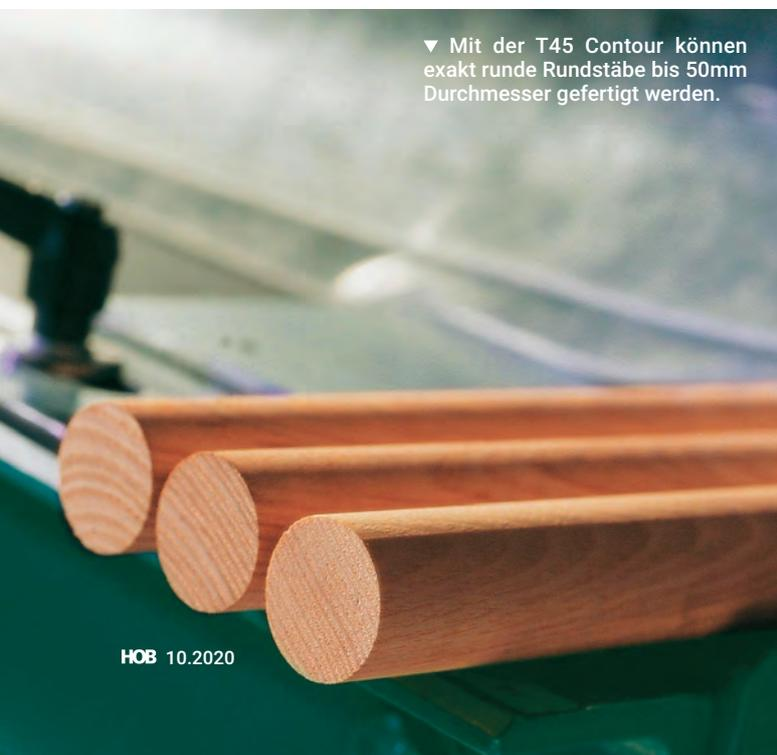
▼ Mit der T45 Contour können exakt runde Rundstäbe bis 50mm Durchmesser gefertigt werden.
