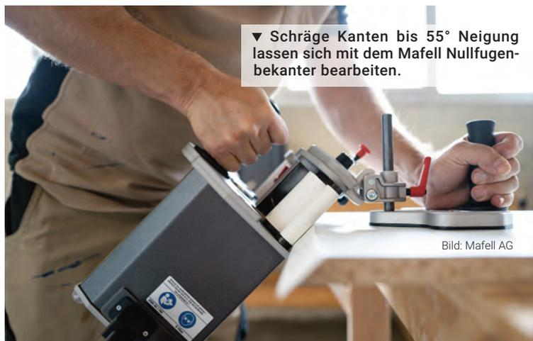
▼ Schräge Kanten bis 55° Neigung lassen sich mit dem Mafell Nullfugenbekanter bearbeiten.
