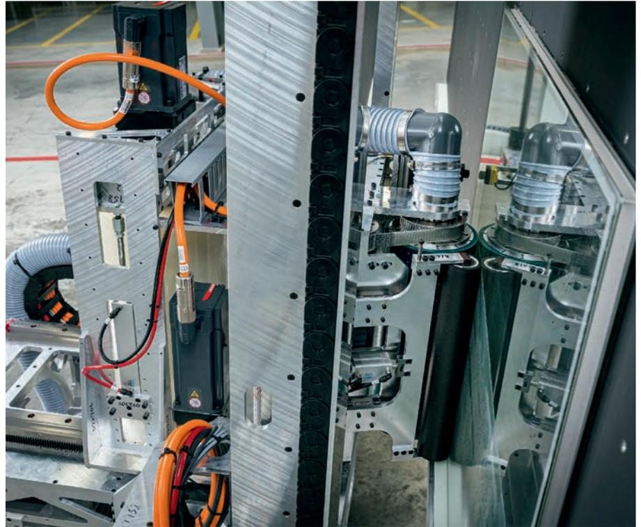
▲ Nach der genauen Vermessung der Isolierglaseinheit trägt das System schützende PET-Fensterfolie in so vielen Durchgängen wie nötig auf, je nach Höhe der Einheit und der Folie.
