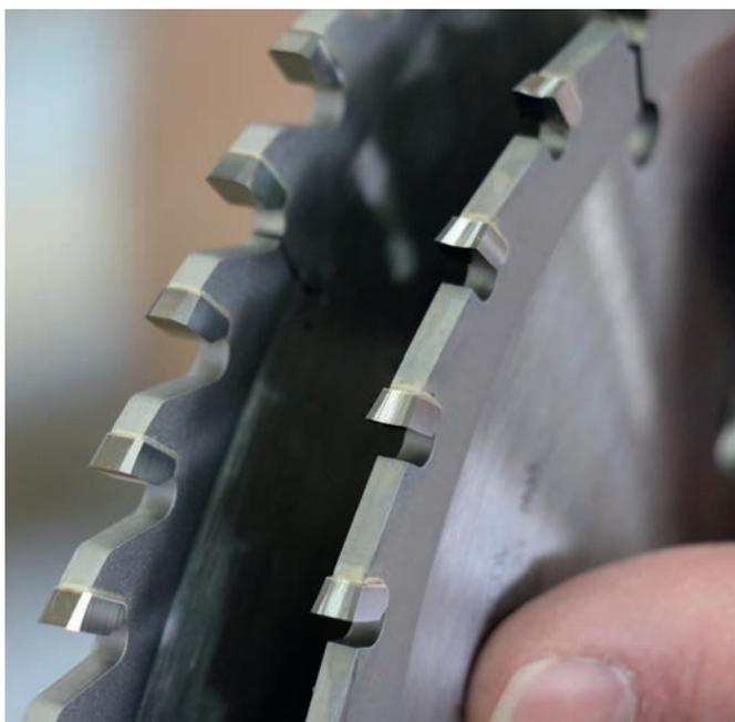
▲ Zum Q-Cut passt ideal das Ritzkreissägeblatt mit der konischen Hohlrückengeometrie.
