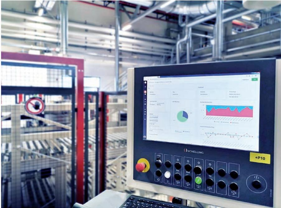
▲ Durch die IIoT- und Serviceplattform Zimba konnte Reiss die Zeit beim Sägeblattwechsel um die Hälfte reduzieren.
