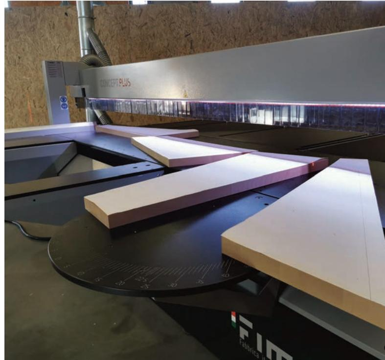
▲ Gleichzeitige Bearbeitung von vier Treppenstufen: Dank der präzisen Schnittlinienanzeige mit Laser und der zuverlässigen Fixierung durch den Druckbalken lassen sich mehrere Teile in einem Durchgang zuschneiden.
