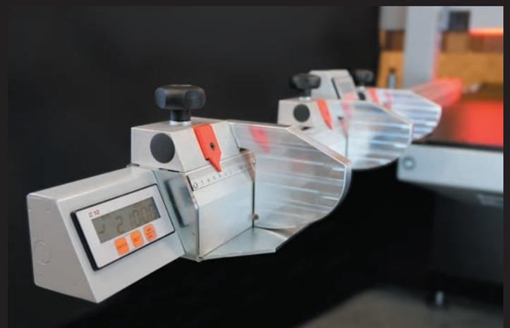
*Am 3400 mm langen Teleskopanschlag lassen sich 3 massive Klappanschläge digital einstellen*
