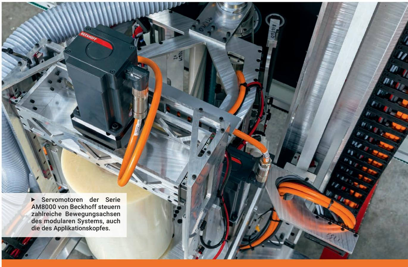
► Servomotoren der Serie AM8000 von Beckhoff steuern zahlreiche Bewegungsachsen des modularen Systems, auch die des Applikationskopfes.
