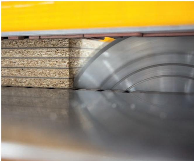
▲ Q-Cut-Plattenaufteilsägeblätter werden für Einzel- und Paketschnitte bis 80mm eingesetzt.
