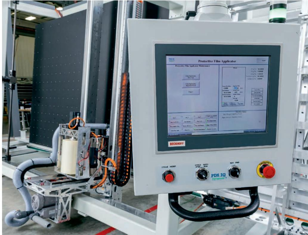
▲ Das modulare Fensterfolien-Auftragssystem von PDS IG Equipment lässt sich leicht in bestehende Anlagen integrieren und über den Economy-Einbau-Panel-PC CP6202 von Beckhoff komfortabel bedienen.
