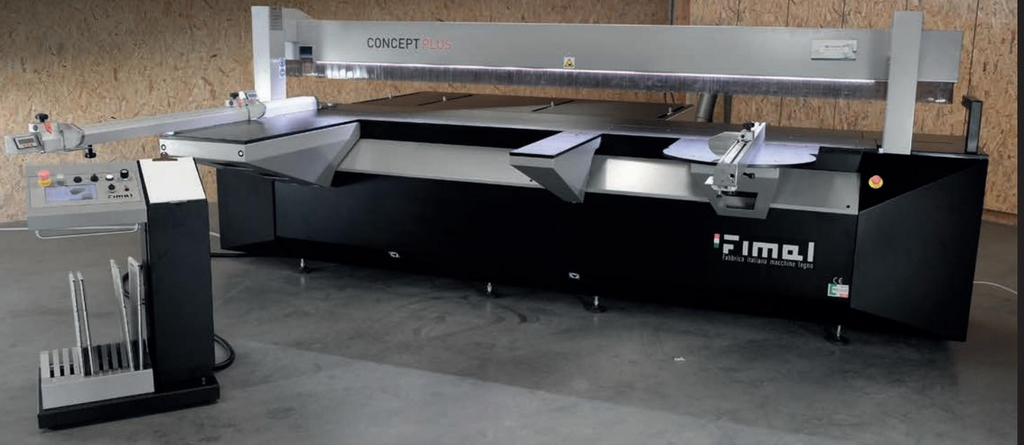
■ Dass diese Säge etwas Besonderes ist, erkennt man auf den ersten Blick, denn ein Druckbalken auf einer so kleinen Maschine ist wirklich eine Seltenheit. Und genau dadurch vereint die Concept 350 Präzision und Sicherheit einer Druckbalkensäge mit den Vorteilen einer Formatkreissäge. Zum echten Fan wird spätestens, wer einmal selbst im Ein-Mann-Betrieb und ohne größere Anstrengungen eine Halbformatplatte an der Concept 350 aufgeteilt hat.
