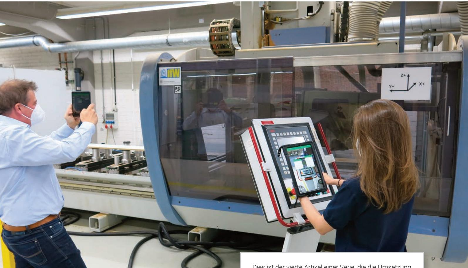
► Bild 1: Schulung mit AR – Werkzeugwechsel an einem Bearbeitungszentrum
