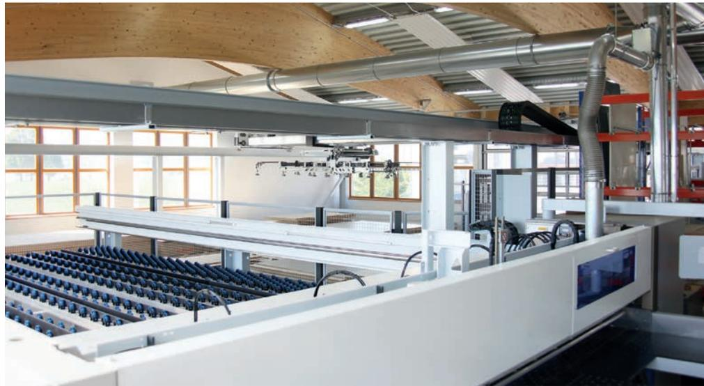
▲ Das automatische Plattenlager Homag-Storeteq S-500 lässt mehr Potenzial für Bearbeitungsmaschinen. Die Kombination mit den Maschinen und vielen Plattenvarianten macht dieses Lagersystem zum Alleskönner.
