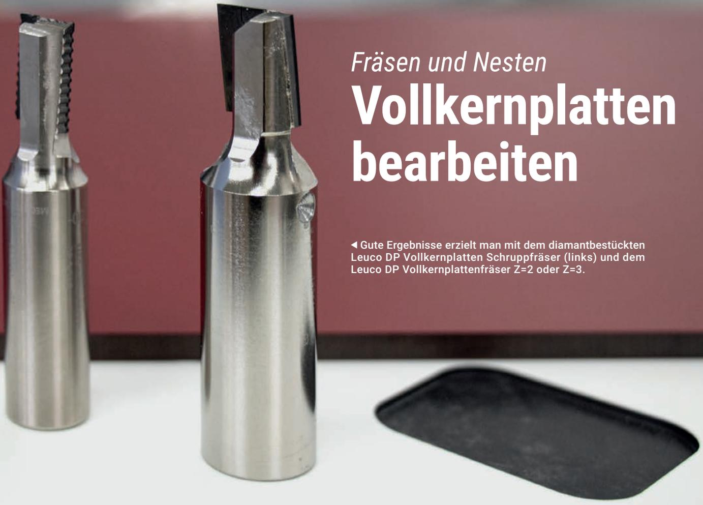
Zum Nesten von Vollkernplatten auf CNC können VHW-Spiral-Schaftfräser oder diamantbestückte (DP) Werkzeuge sehr gut eingesetzt werden. HW-Fräser sind hierbei für kleine Bearbeitungsmengen ausreichend. Diamantbestückte Werkzeuge, idealerweise mit durchgehenden Schneiden und leichten Achswinkeln, bieten hohe Bearbeitungsqualität und erheblich längere Standzeiten. Der Beitrag gibt praktische Tipps, wie Vollkernplatten im Nesting-Verfahren bearbeitet werden.
