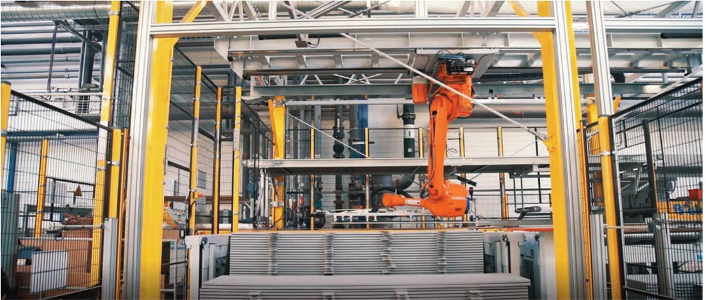
▲ Die zu handhabenden Bretter kommen in Stapeln mit einer Abweichung von  $\pm 150\text{mm}$  und müssen in Kartons gelegt werden, die sich ständig in Bewegung befinden.
