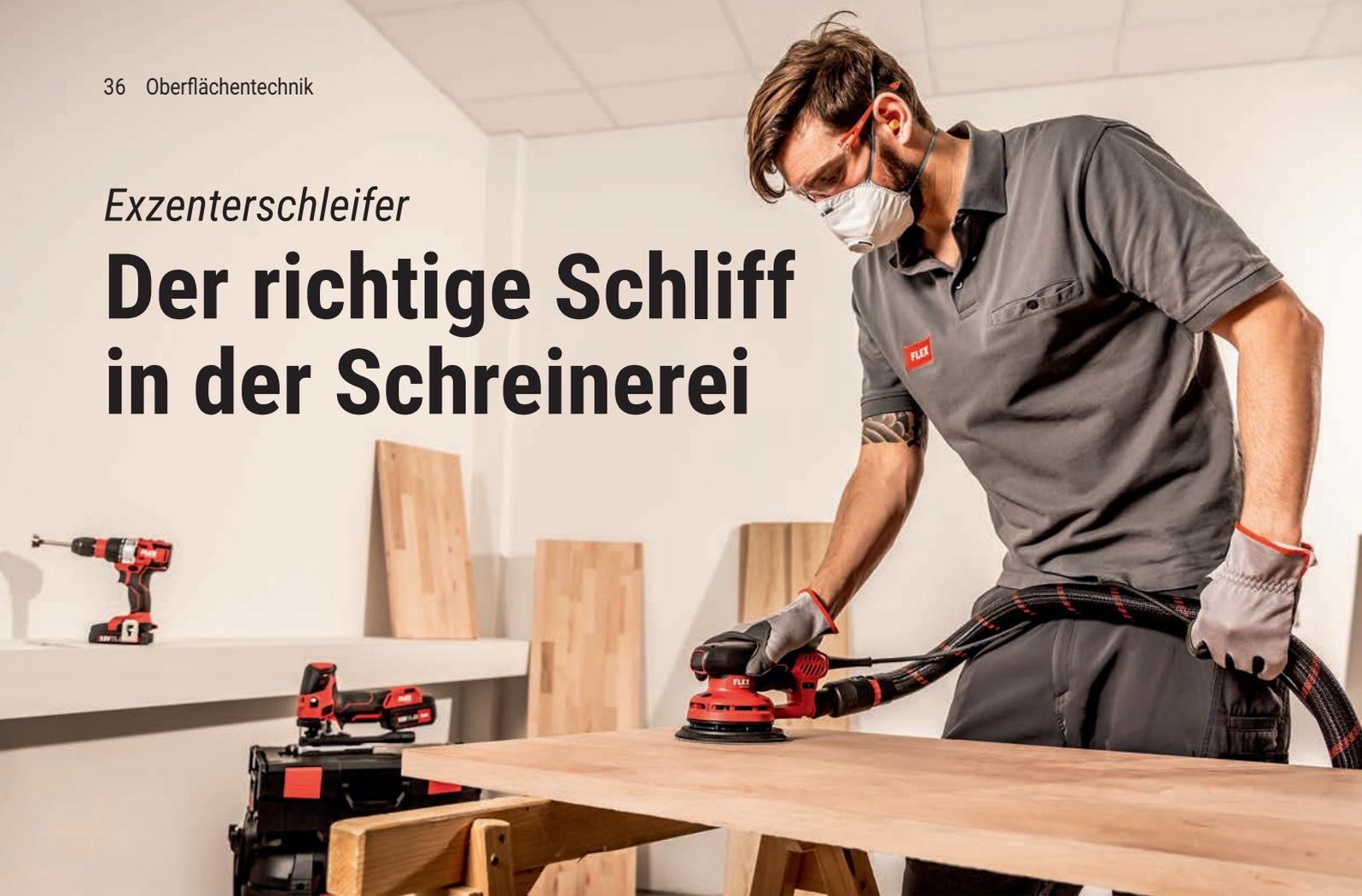
▲ Der Exzentrerschleifer ORE 5-150 EC kommt bei der Schreinerei Formart für Grob- und Massivholzschliff zum Einsatz und eignet sich auch zur Lackentfernung oder zum Schleifen von Kunststoffen und Metall.
