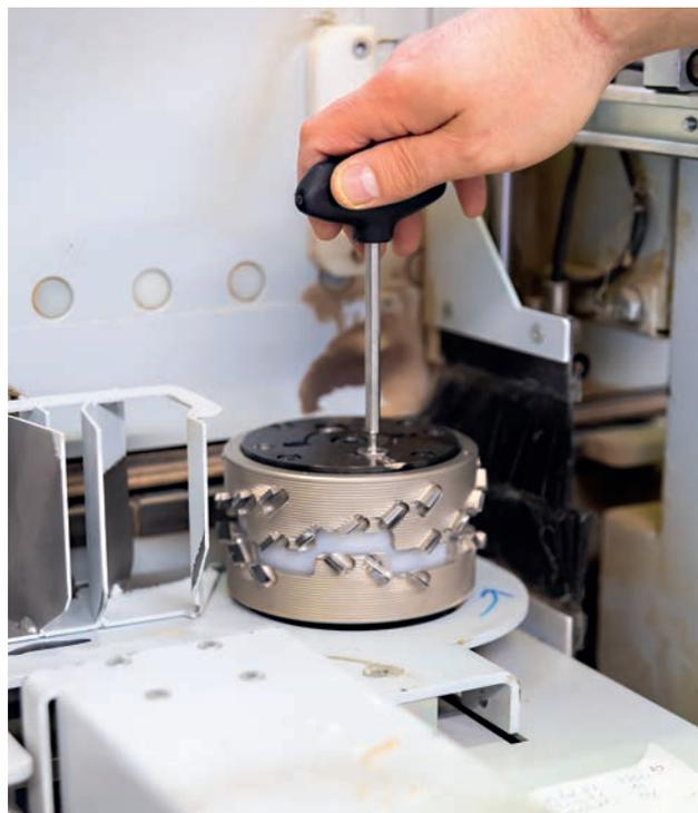
► In der Maschine werden die beiden Fräserhälften minimal zueinander mittels einer Drehung mit einem Inbusschlüssel zueinander geführt. Nach nur max. 8 Minuten Maschinenstillstand kann mit einem frisch geschärften Abschnitt der Schneide weiter gefügt werden
