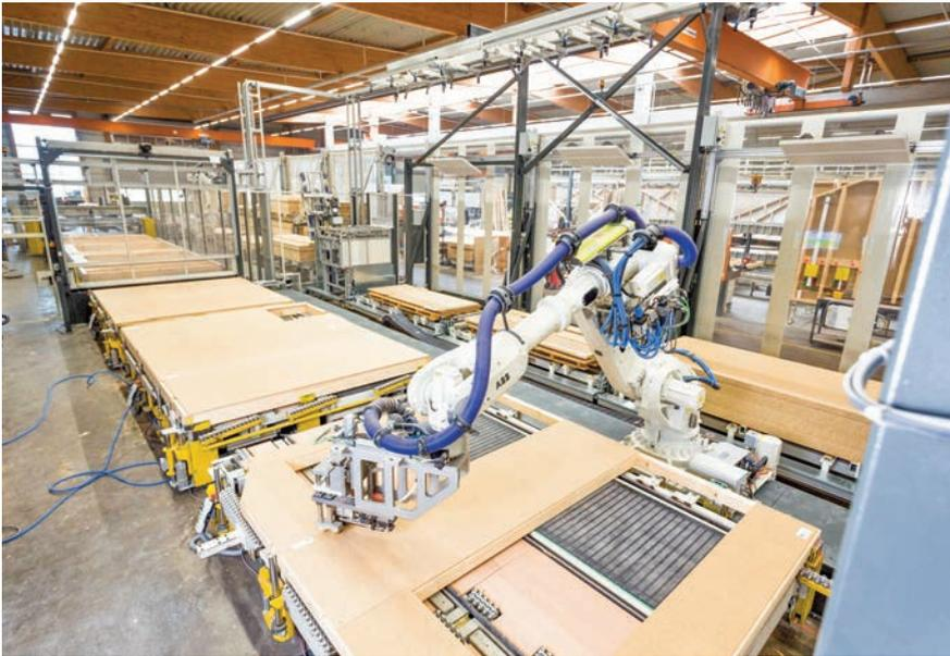
► Das Klammern der Platten übernimmt der Roboter anhand definierter Klammerbahnen und -winkel.
