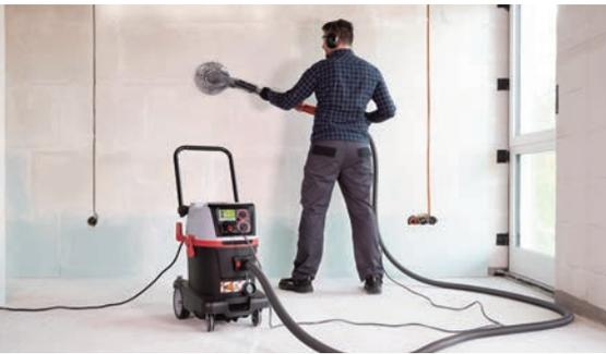
Die neue Modellreihe CraftiX von Sprintus besteht aus vier zertifizierten Sicherheitssaugern für die Staubklassen L und M. Sie verfügen über eine automatische Filterabreinigung. Diese erfolgt dank
