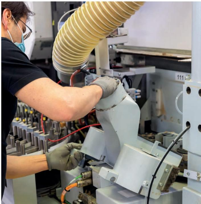
komakte Ausführung für die Motorwelle mit 30mm Durchmesser passt in diese Maschine. Es arbeitet dort mit 20m/min Vorschub. „Der Übergang von der Plattenoberfläche zur Kante muss sauber, gerade und eben sein, denn wir fertigen dort echte Nullfugen-Qualität“, erklärt Konrad Schurr. „Dafür hat die Homag-Maschine eine Lasereinheit, die die Klebeschicht aufschmilzt. Das erzeugt eine dichte und langfristig haltbare Verbindung. Unebenheiten an den Kanten würden leicht zu Produktfehlern führen.“
