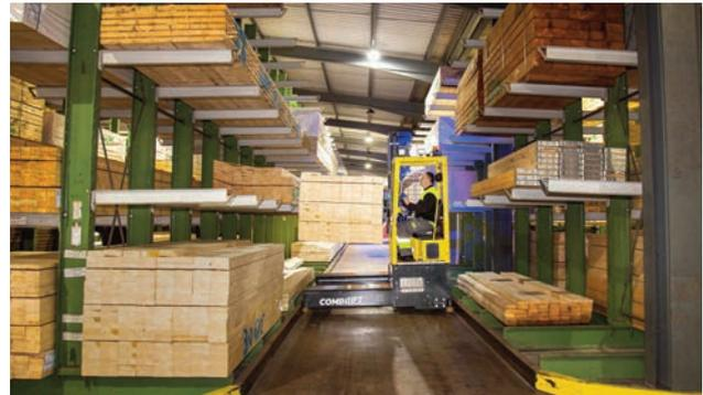
des Joysticks nach rechts oder links, simultan verstellen - wodurch eine Hundengelenkung und ein Richtungswechsel während der Fahrt möglich sind.
