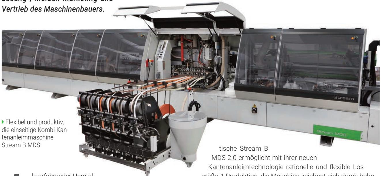
► Flexibel und produktiv, die einseitige Kombi-Kantenanleimmaschine Stream B MDS
