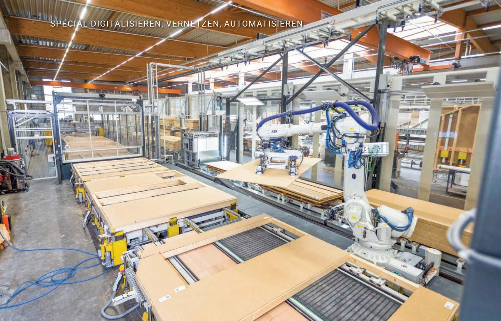
► In der Anlage zur automatisierten Wandproduktion für Fertighäuser vereinen sich Ergonomie, Prozesssicherheit und Flexibilität. Denn jedes 'Finger-Haus' ist ein Unikat.
