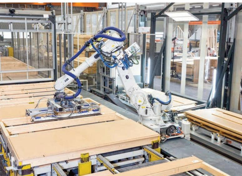
► Ein hochmodernes Kamerasystem erkennt die Lage der Holzwerkstoff- und Gipsbauplatten und übermittelt diese Daten über eine eigens entwickelte Software an den Roboter.
