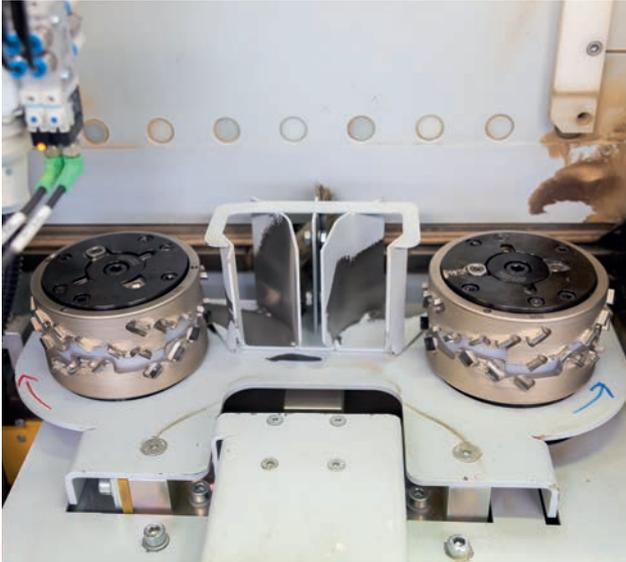
► Ein weiterer Vorteil der synchronen Verstellung zeigt sich bei einem Konzept mit zwei Werkzeugen im Wechselfräsen: Der Fügefräser im Gleichlauf mit deutlich weniger Laufmetern und weniger Abnutzung muss weniger häufig nachgestellt werden. Bislang wurden in der Regel beide Fräser gleichzeitig gewechselt, obwohl ein Fräser schwächer abgenutzt wurde.
