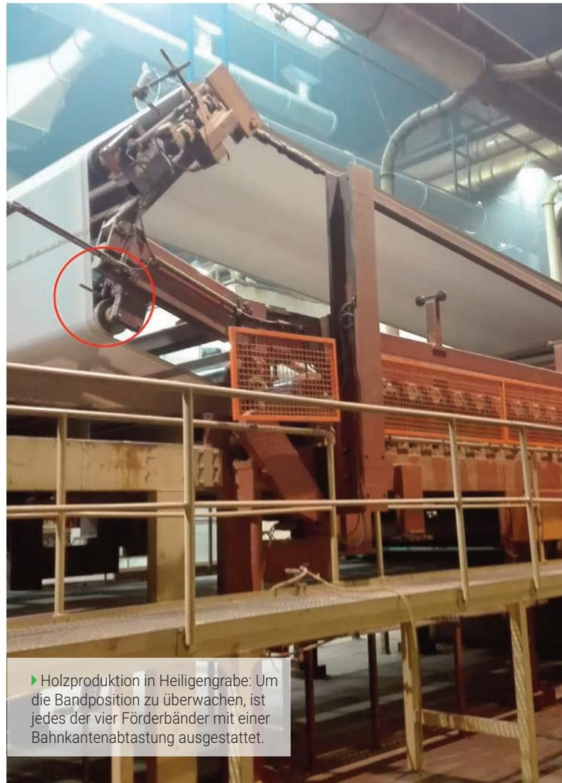
► Holzproduktion in Heiligengrabe: Um die Bandposition zu überwachen, ist jedes der vier Förderbänder mit einer Bahnkantenab-
