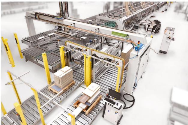
► Die überarbeitete Stream B MDS 2.0 mit neuer Kantenleimtechnologie für rationelle und flexible Losgröße-1-Fertigung
