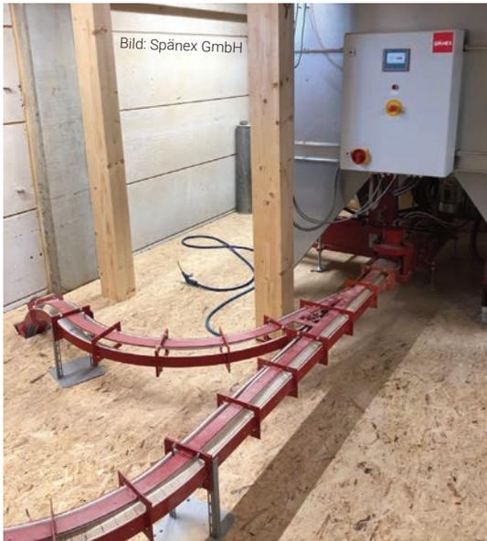
▲ Über eine Weiche in der Transportschiene lassen sich die Briketts bei Erreichen des zulässigen Silo-Füllstandes alternativ in einen Big Bag zur Entsorgung fördern.
