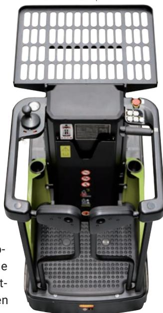
◀ Die höhenverstellbare Ablage ist mit Längsschlitzern ausgerüstet, sodass der Bediener gute Sicht nach unten hat.
