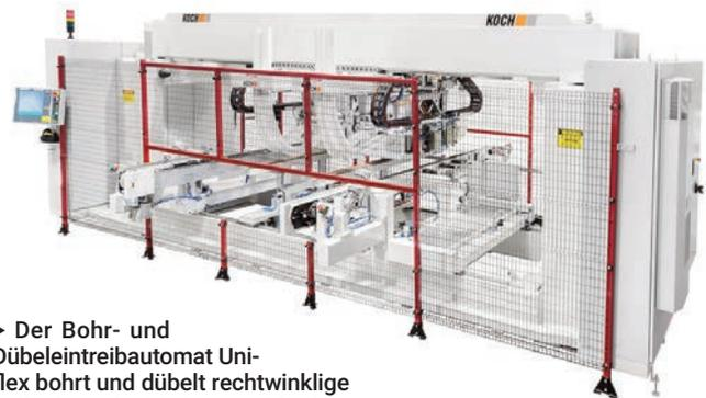
► Der Bohr- und Dübeleintreibautomat Uniflex bohrt und dübelt rechteckige Teile doppelseitig im Durchlauf
