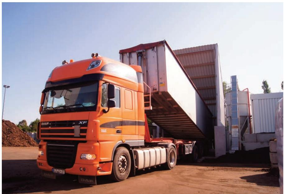
▲ Die PKT-Anlage mit integrierter Wägesteuerung minipond 3F ist ausgelegt auf eine jährliche Verpackungsleistung von 20.000t und bis zu 600 Säcken pro Stunde
