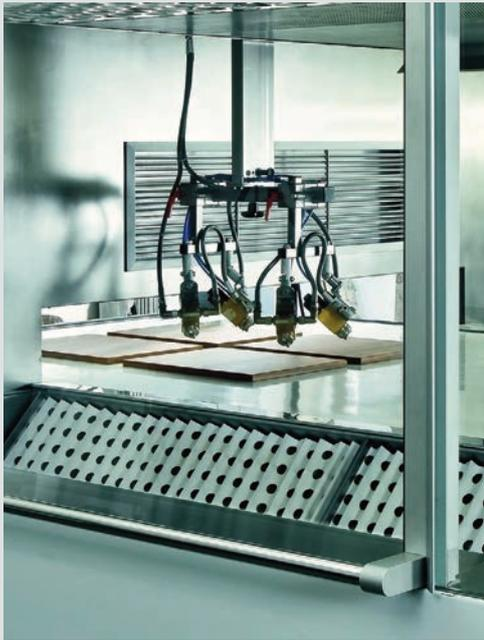
▲ Für ein verbrauchsoptimiertes Beschichten können in der Maschinensteuerung spezielle Programme hinterlegt werden.
