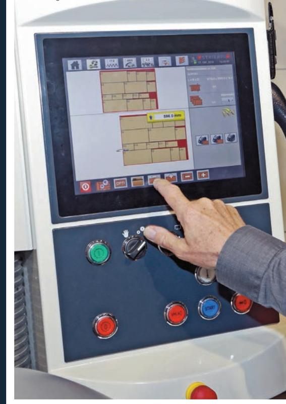
▲ Bedient wird die Control über ein HMI und einen 12"-Touchscreen
