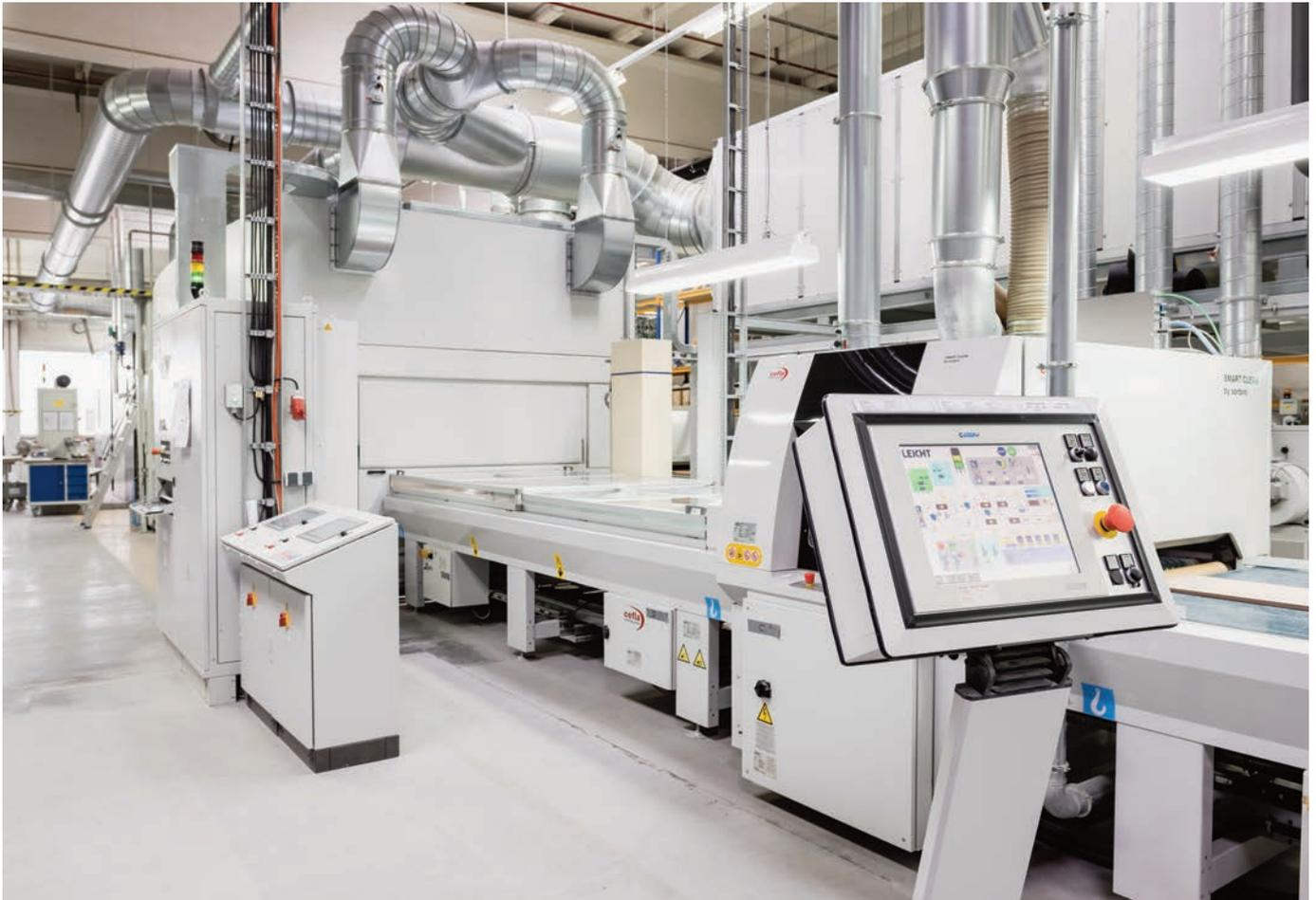
▲ Beim Lackieren von MDF- und Holzplatten arbeitet Leicht Küchen mit einer Flachbeschichtungsanlage samt integriertem Roboter.
