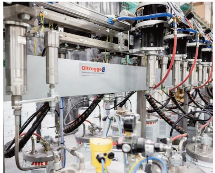
▲ Das Farbmanagement realisierte Oltrogge mit zwei Dosieranlagen vom Modell Regular 30, die in die Flachbeschichtungsanlage integriert wurden.
