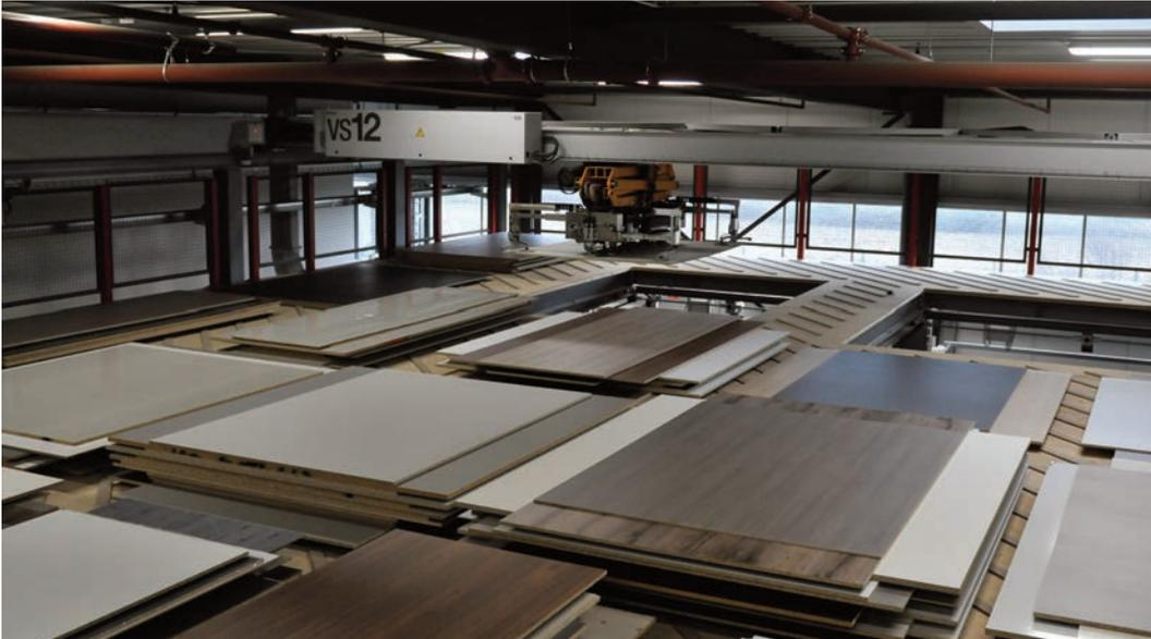
▲ Für die effiziente Nutzung von Reststücken bietet das Restelager über der Is 1 bis zu 40 Stapelplätze.
