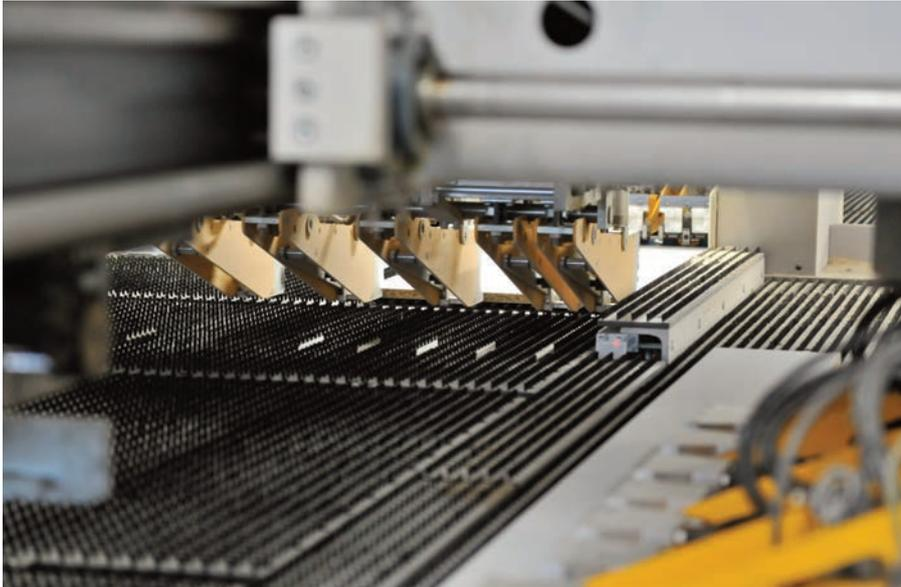
▲ Für den Zuschnitt von Korpusteilen und Rückwänden setzt Rotpunkt die Is 1 von IMA Schelling ein.
