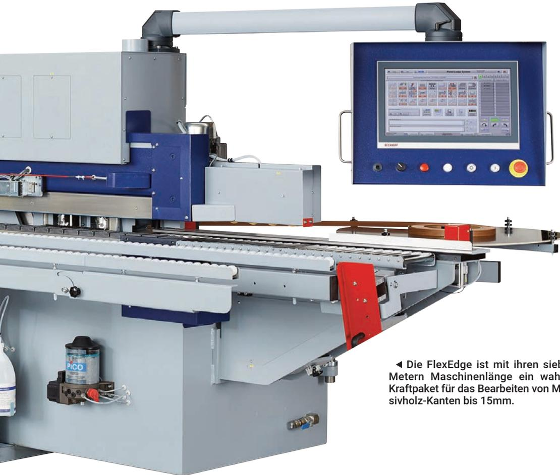
◀ Die FlexEdge ist mit ihren sieben Metern Maschinenlänge ein wahres Kraftpaket für das Bearbeiten von Massivholz-Kanten bis 15mm.
