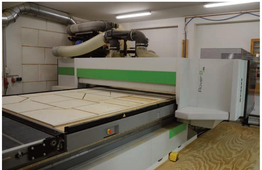
▲ Das CNC-gesteuerte Nesting-BAZ Rover B vom italienischen Maschinenbauer Biesse macht nicht nur den Zuschnitt, sondern auch Fräsungen und Bohrungen.
