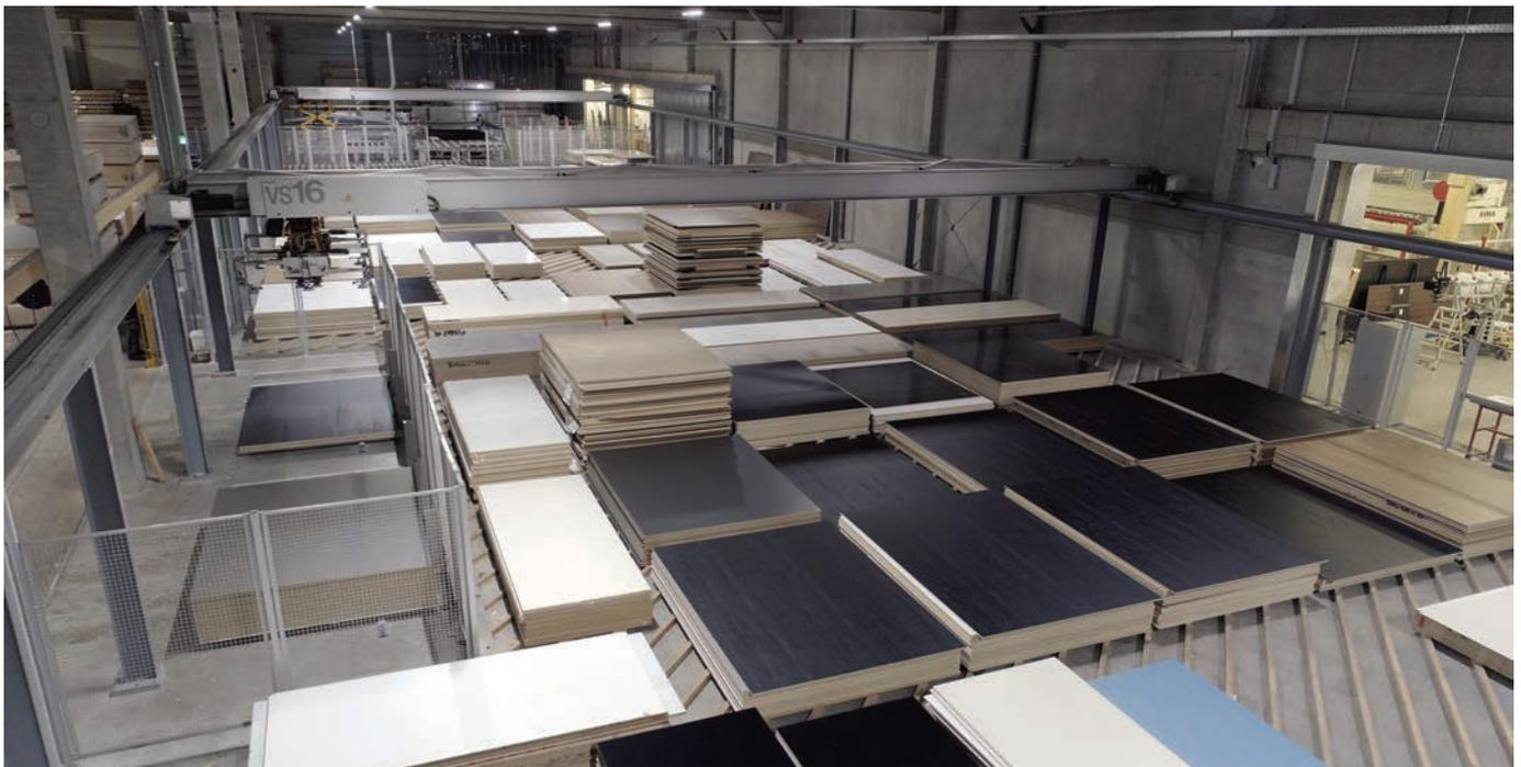
▲ Flächenlager mit zwei Brücken und Einlagerplatz
