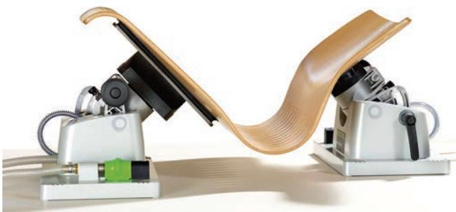
▲ Mit einer optionalen zweiten Spanneinheit lassen sich auch komplexe Teile sicher spannen.
