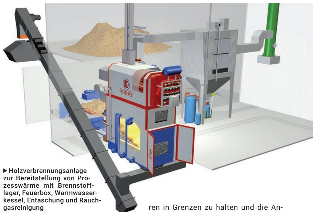
► Holzverbrennungsanlage zur Bereitstellung von Prozesswärme mit Brennstofflager, Feuerbox, Warmwasserkessel, Entaschung und Rauchgasreinigung
