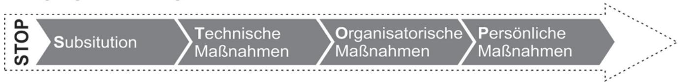
▲ Abbildung 4: Rangfolge der Maßnahmen zur Reduzierung der Staubbelastung am Arbeitsplatz
