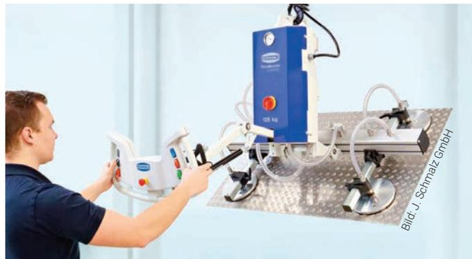
▲ Mit dem optimierten Griff im ergonomischen Design und dem neugestalteten Steuerpanel kann der Anwender das Vakuum-Hebegerät VacuMaster Comfort ganz bequem und intuitiv bedienen.
