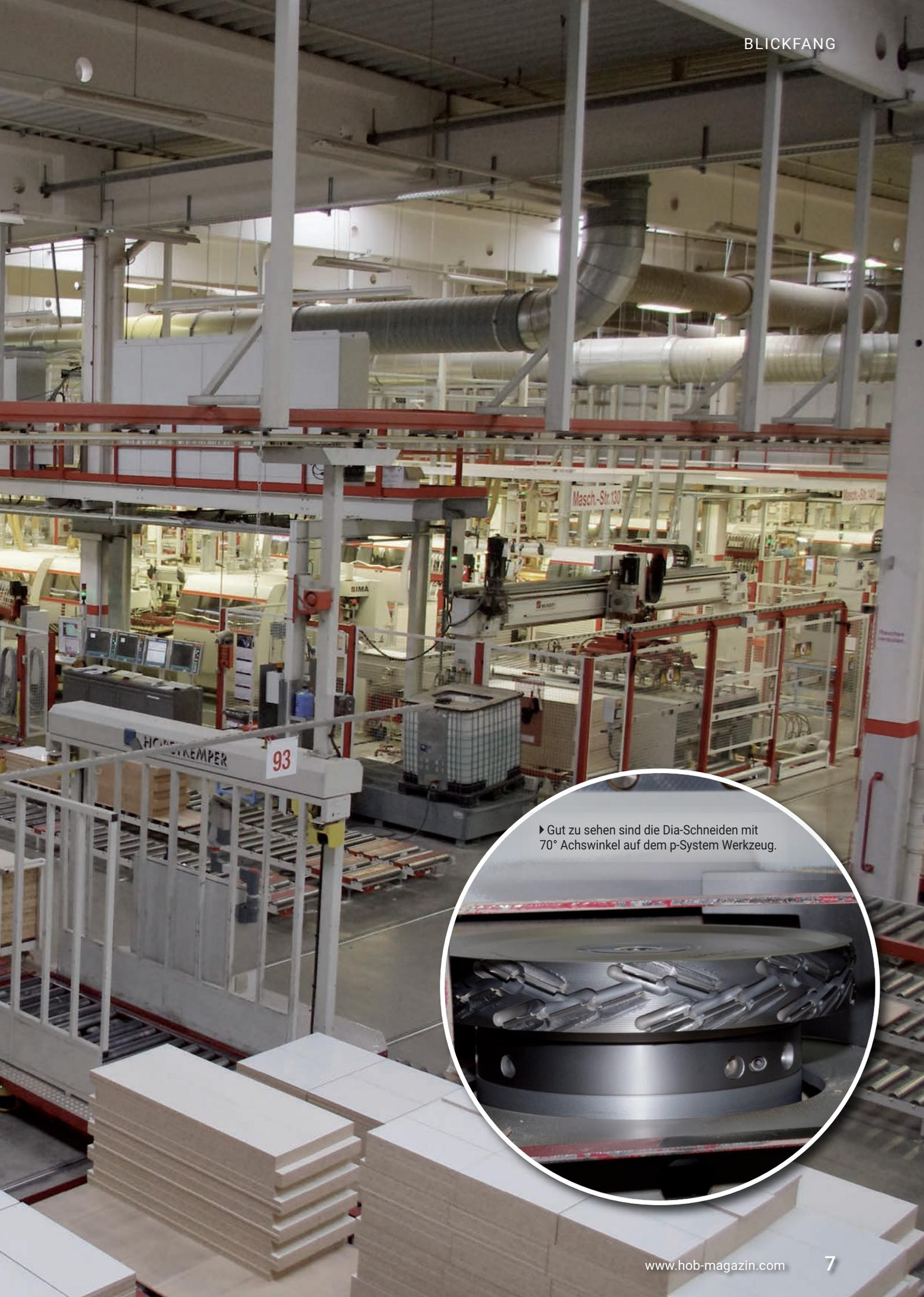
► Gut zu sehen sind die Dia-Schneiden mit 70° Achswinkel auf dem p-System Werkzeug.
