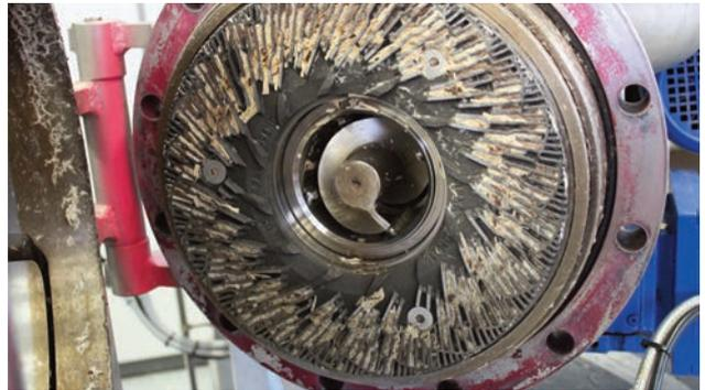
Unter dem Akronym 'OptiFaser' wurden Mahlplatten für die Erzeugung spezifischer Fasergeometrien für Faserverbundwerkstoffe mit geringer Dichte entwickelt.
