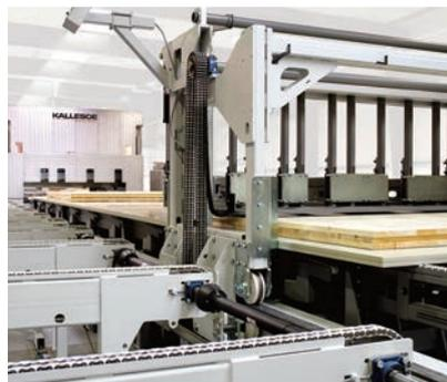
beim trockenen Brett. System TM liefert die Anlagentechnik für die Leimholzproduktion auf Basis von Hochleistungskappsägen und auch Keilzinkanlagen. Die Kernkompetenz liegt dabei in der Holzoptimierung.
