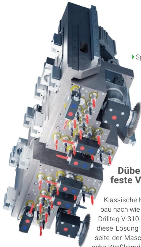
► Split-Head Bohrgetriebe, um spiegelbildliche Werkstücke simultan bearbeiten zu können.
