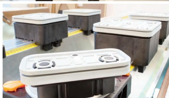
► Der Saugercup kann mit den orangenen Klemmhebeln in 15-Grad-Schritten in der Aufnahme werkzeuglos fixiert werden.
