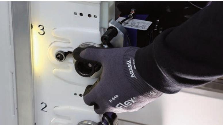
► Das optische LED-Assistenzsystem IntelliGuide gibt beim Werkzeugwechsel die Platzbelegung vor.
