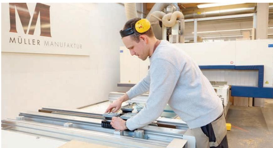
► Kurze Rüstzeiten: Das Verstellen der drehbaren Blocksauger und das Wechseln der Saugplatte gestalten sich für Schreiner Michael Spinner schnell, einfach und werkzeuglos.
