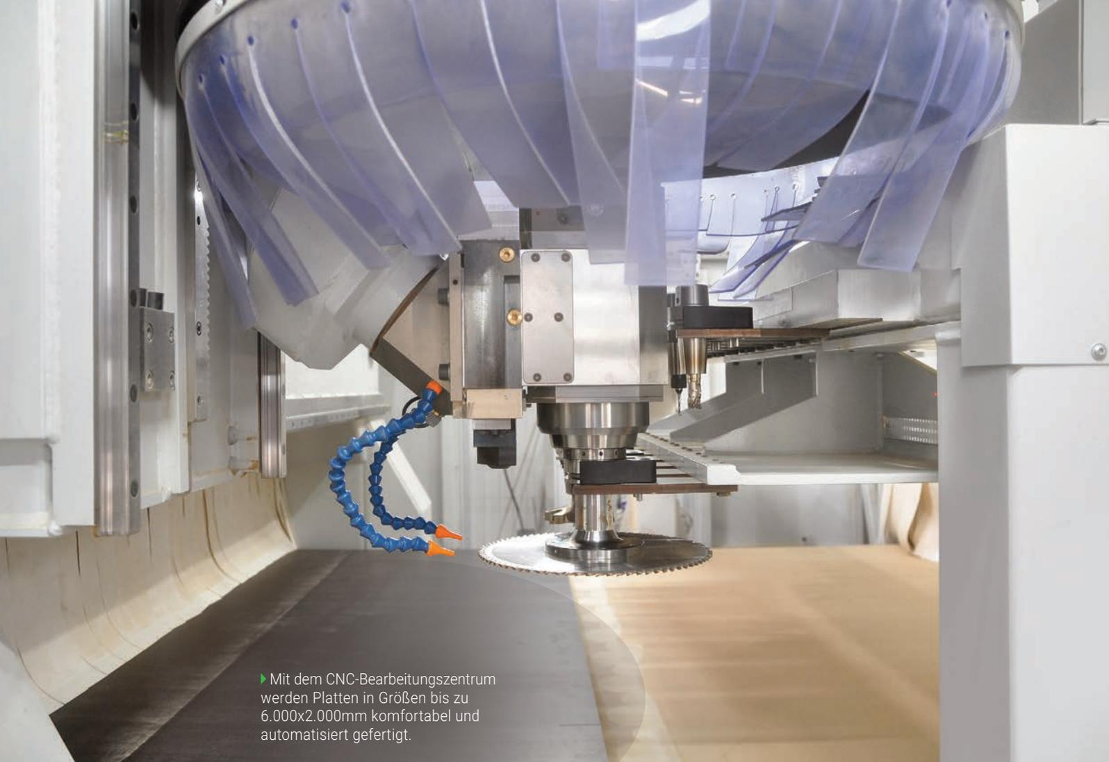
▶ Mit dem CNC-Bearbeitungszentrum werden Platten in Größen bis zu 6.000x2.000mm komfortabel und automatisiert gefertigt.
