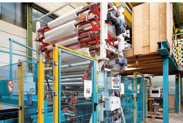
► Die Folienabrollvorrichtung sorgt für den Vorschub und die virtuelle Achse des Antriebssystems Movi-C spendet die Folie Millimeter genau. Die Achse legt auch das genaue Maß und die exakte Positionierung der Folie über der Palette fest.
