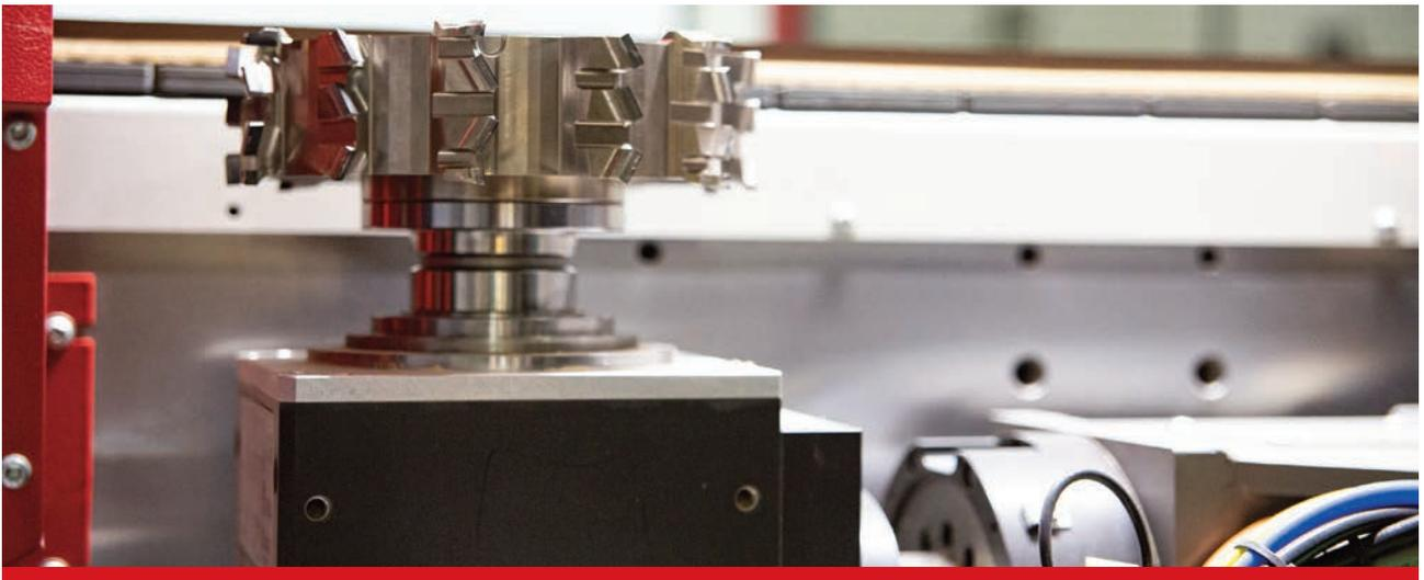
► Auf möglichst wenig Werkzeugplätzen werden mit möglichst wenigen Werkzeugen maximal viele Kantenausbildungen umgesetzt, z.B. Fasen, Nuten, Falzen. Die Steuerung der Maschine taktet das Werkzeug zum Werkstück.
