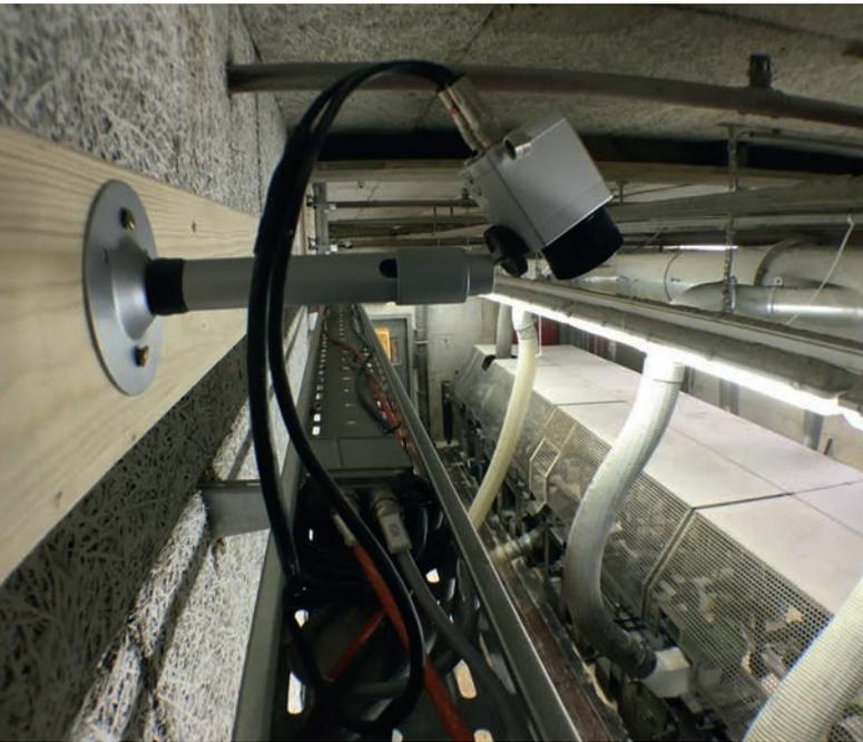
► Die installierte Infrarotkamera PI 640 von Optris überwacht die Hobelinie.
