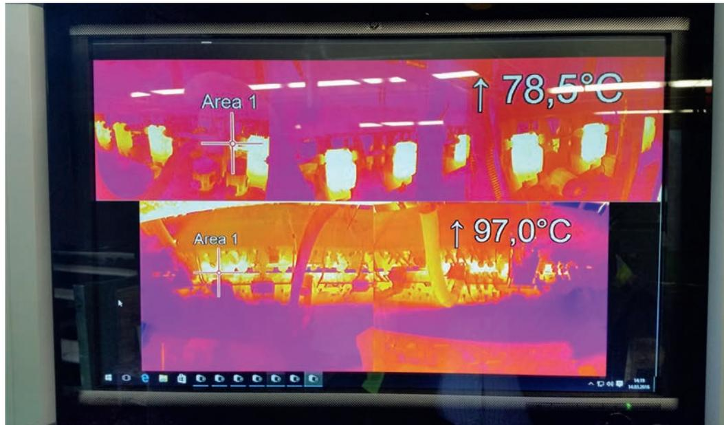
Die Software PIX Connect ermöglicht die Überlappung mehrerer Wärmebilder zu einem Gesamtbild (Merging-Modus). Der Vorteil ist, dass der heißeste Punkt (Hotspot) auch innerhalb des Gesamtbildes detektiert werden kann.
