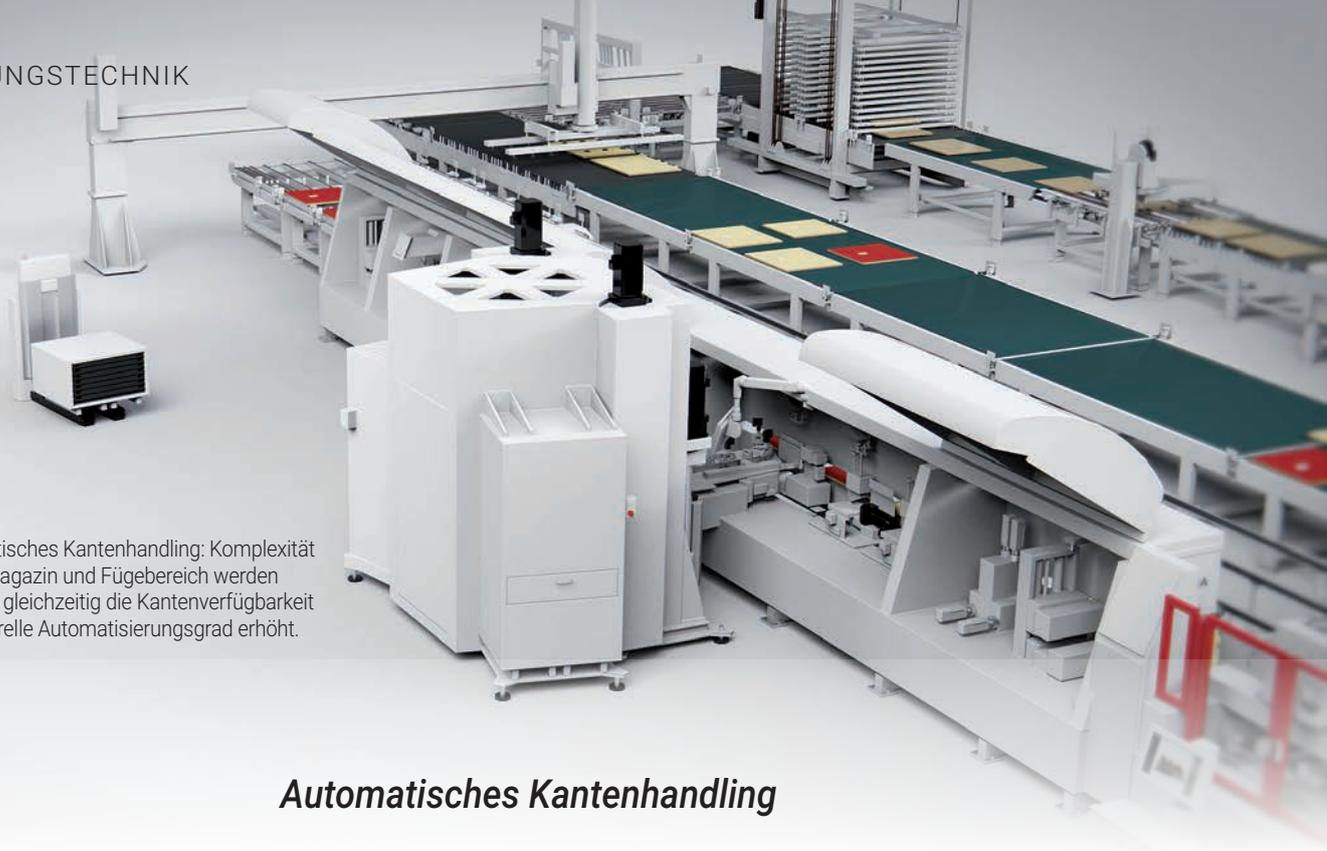
► Vollautomatisches Kantenhandling: Komplexität von Kantenmagazin und Fügebereich werden reduziert und gleichzeitig die Kantenverfügbarkeit und der generelle Automatisierungsgrad erhöht.
