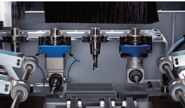
► Der Vierfach-Linearwechsler garantiert einen schnellen Werkzeug- und Aggregatwechsel.
