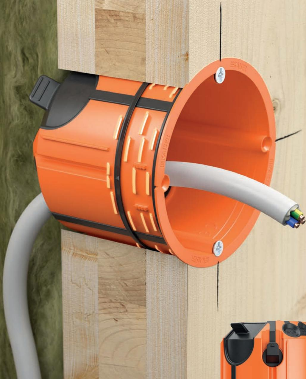
Die neue KAISER **Geräte-Verbindungsdose O-range ECON® Fix** mit laschenloser Klemmrippen-Befestigung für die sichere Installation in unterschiedlichen Wandaufbauten wie OSB-Platten, Brettsperr- oder Massivholz.
