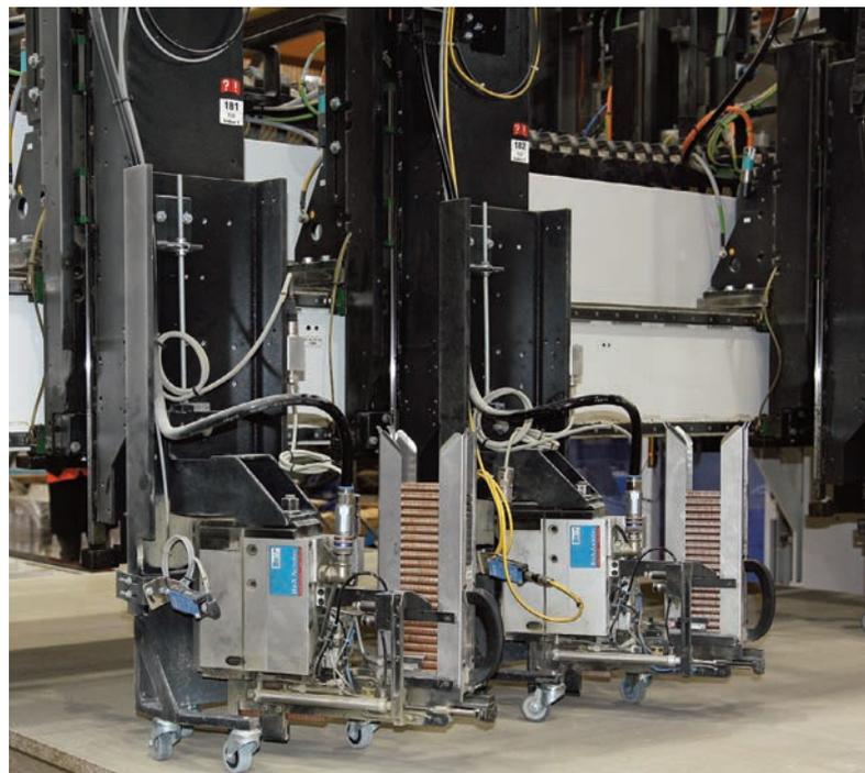
► Die drei BeA Autotec Kassettengeräte werden von der Multifunktionsbrücke über die Beplankung geführt.
