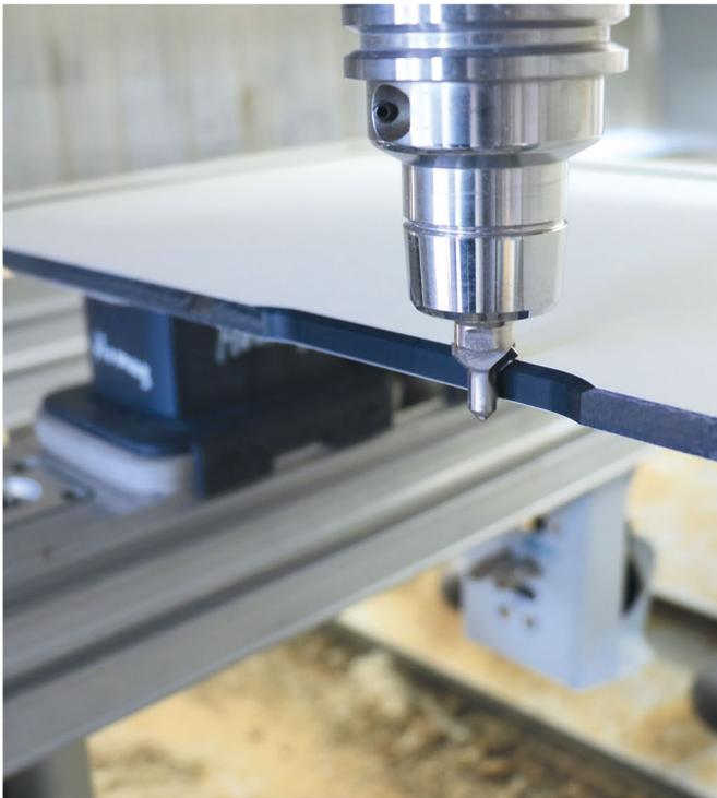
► DP Multifunktions-Bohr-/Fasefräser: Mit nur einem Werkzeug kann der Anwender wahlweise fügen, Ausschnitte fräsen, bohren, senken oder fäsen.
