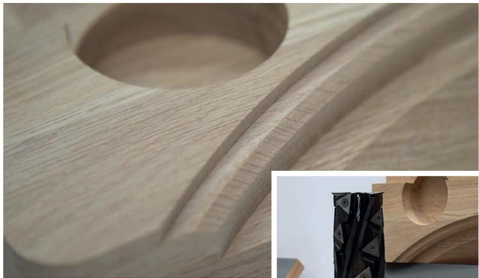
► (Bild oben) Anwendungsbeispiele: Ausrissfreies spiralförmiges Eintauchen, Fälzen und Fasen
