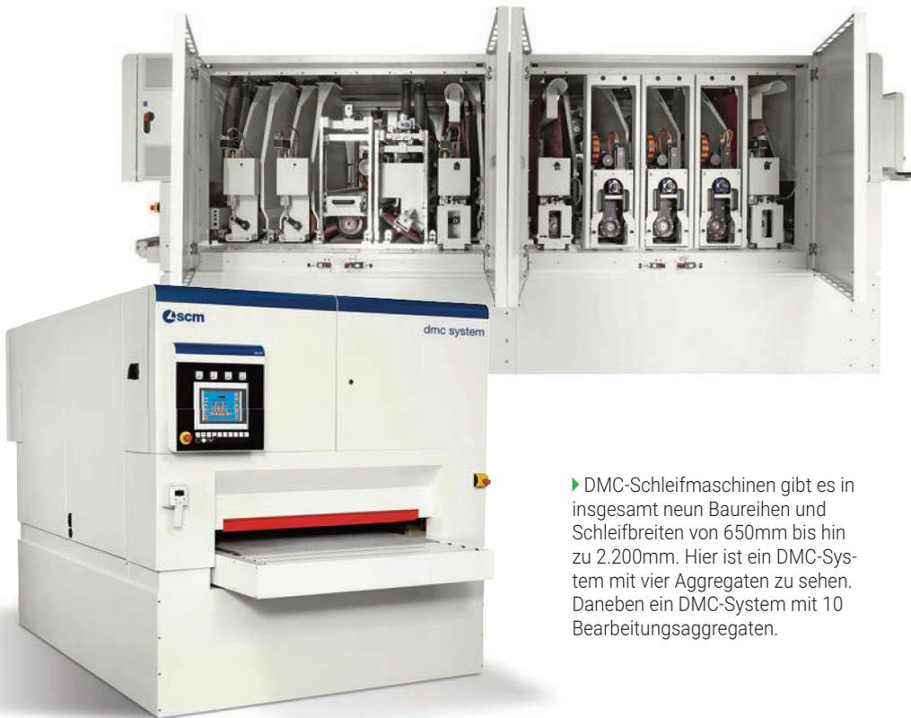
► DMC-Schleifmaschinen gibt es in insgesamt neun Baureihen und Schleifbreiten von 650mm bis hin zu 2.200mm. Hier ist ein DMC-System mit vier Aggregaten zu sehen. Daneben ein DMC-System mit 10 Bearbeitungsaggregaten.
