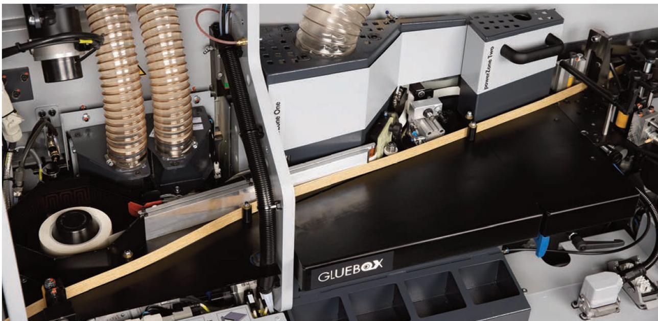
► Hitze- und Wasserbeständigkeit, eine minimale Leimfuge sowie ein reduzierter Klebverbrauch – alle Vorteile des PUR-Klebers können mit der glueBox kompromisslos genutzt werden.
