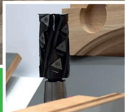
flächen- und Kantenbearbeitung erreicht wird, die Rückseite des Messers steht dabei nicht vor. Genau die unterscheidet das t3-System von anderen Sprialmesserköpfen. Bei viereckigen Wendeplatten zieht die äußerste Schneide immer in Richtung Kante. Diese Schnittrichtung führt zu unsaubereren Kanten. Das t3-System kennt dieses Problem nicht.
