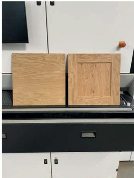
► Massive Rahmentüren werden bei Siebe & Breder Holztechnik mit der Planetenkassette final veredelt.
