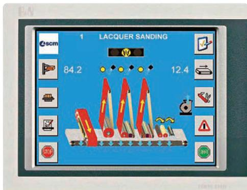
► Um die vielfältigen Bearbeitungsmöglichkeiten der Maschinen einfach zu verwalten und zu bedienen sind sie mit einem großen 17"-Touchscreen ausgestattet.
