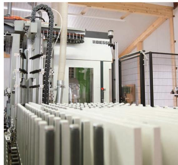
► Die Werkstücke in Warteposition vor dem Maschineneinlauf.
