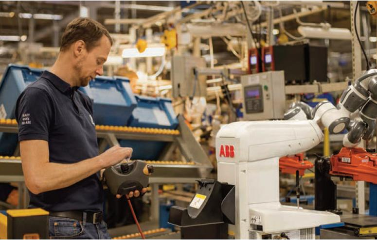
► Husqvarna schätzt die hohe Wiederholgenauigkeit des ABB-Cobots sowie die Tatsache, dass weniger Fehler bei der Montage auftreten. Im Falle eines Problems ist es für die Teamleiter an der Produktionslinie zudem ohne weiteres möglich, einzugreifen und den Prozess erneut zu starten.
