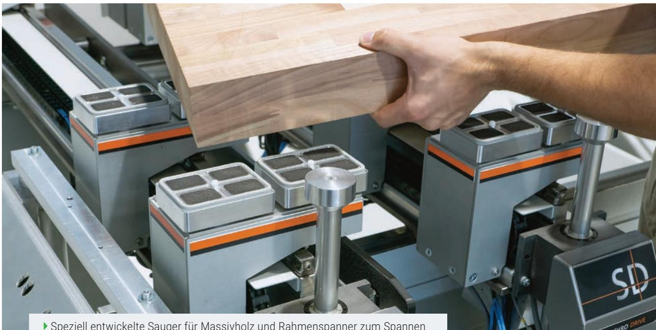
► Speziell entwickelte Sauger für Massivholz und Rahmenspanner zum Spannen von Leisten und Profilen machen den SynchroDrive-Tisch noch effizienter.
