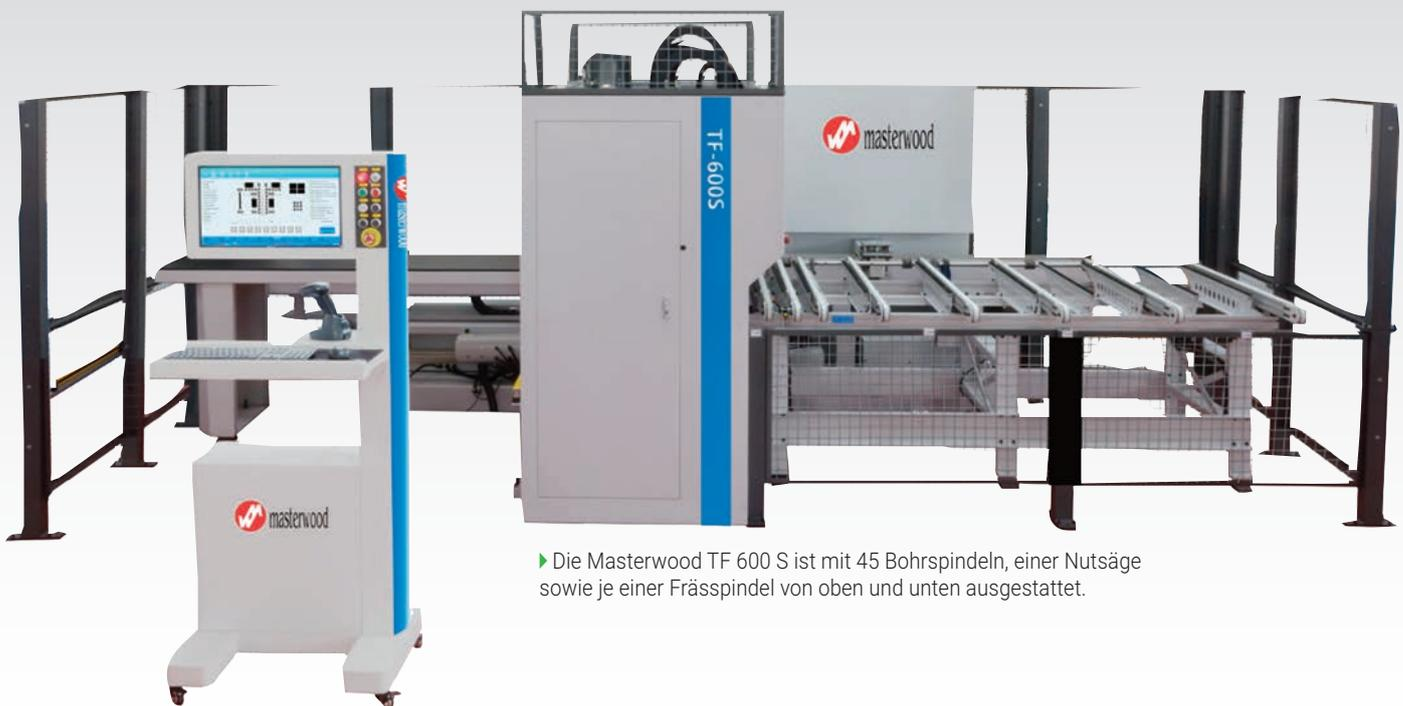
► Die Masterwood TF 600 S ist mit 45 Bohrspindeln, einer Nutsäge sowie je einer Frässpindel von oben und unten ausgestattet.
