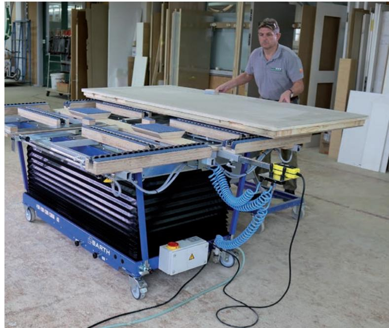
► Pneumatisch aktivierbare Röllchenleisten machen den Tisch noch komfortabler und effizienter. Das erleichtert das Beschicken über zuführende Rollenbahnen und das Positionieren schwerer Werkstücke auf dem Tisch durch eine einzelne Arbeitskraft.
