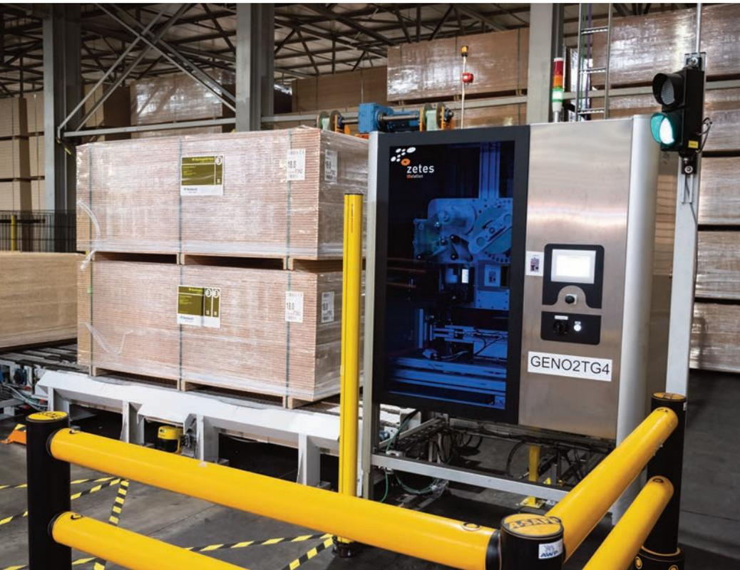
► Nachdem die Paletten in Folie verpackt werden, bringt die Maschine – immer an derselben Stelle – das Etikett auf und scannt automatisch den Barcode mit Lagerstandort und Chargennummer. Dann sorgt ZetesAtlas dafür, dass die Palette in der Warehouse-Management-Software von Norbord korrekt angezeigt wird.
