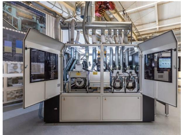
► Modularer Systemaufbau für ein variabel skalierbares Maschinendesign mit unterschiedlich vielen Schleifaggregaten.
