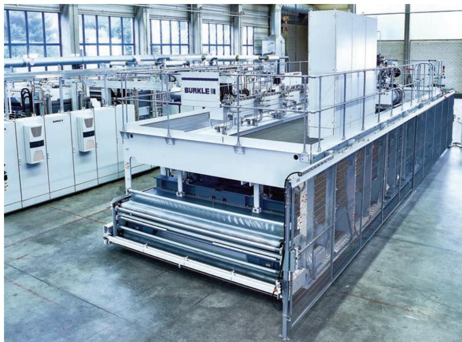
Die Bürkle ODW-Kurtaktpresse ist mit über 60qm Grundfläche, knapp 4m Höhe und einem Gewicht von über 100t eine beeindruckende Erscheinung. Die über der Presse angebrachte Arbeitsbühne schützt die Presse vor Verschmutzung von oben, dient zum Aufstellen des Schaltschranks und des Hydraulikaggregates und erleichtert gleichzeitig den Zugang bei notwendigen Wartungsarbeiten.
