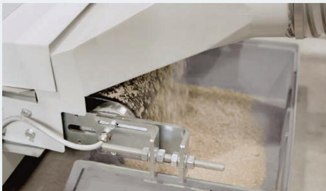
► Wo gefräst wird, fallen auch Späne! Das in den Maschinenständer integrierte, platzsparende Späneförderband befördert auch große Spanmengen verlässlich zur Absaugung.
