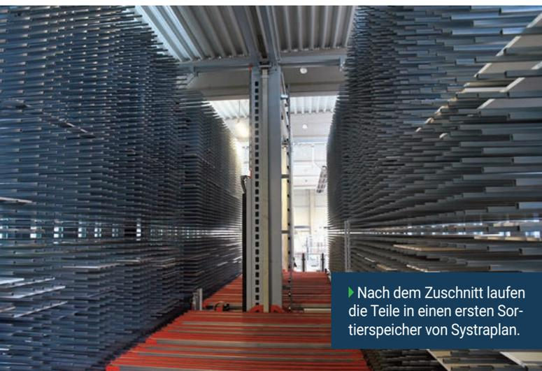
► Nach dem Zuschnitt laufen die Teile in einen ersten Sortierspeicher von Systraplan.
