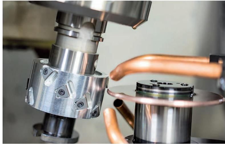
► Die speziell entwickelten Diamant-Wechselschneiden lassen sich mehrfach im Werkzeug nachschärfen. Alternativ können die Wechselschneiden auch direkt vom Anwender selbst ausgetauscht werden.
