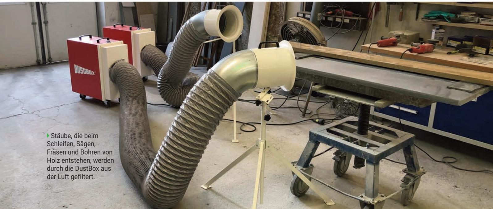
► Stäube, die beim Schleifen, Sägen, Fräsen und Bohren von Holz entstehen, werden durch die DustBox aus der Luft gefiltert.
