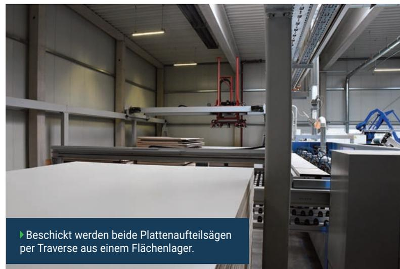
► Beschriftet werden beide Plattenaufteilsägen per Traverse aus einem Flächenlager.
