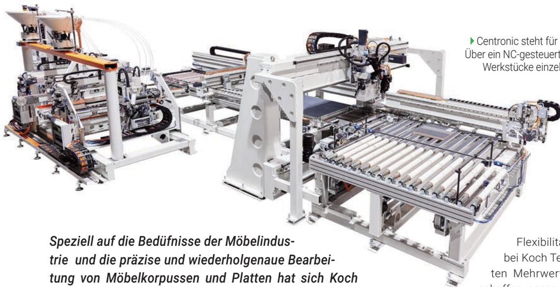
► Centronic steht für einen flexiblen Arbeitsablauf. Über ein NC-gesteuertes Greifersystem werden die Werkstücke einzeln der Bearbeitung zugeführt.
