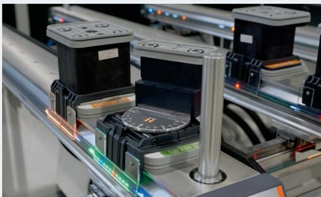
► Der Holz-HerLED-Tisch mit Visual Setting sorgt für extrem schnelles, fehlerfreies und sicheres Rüsten – auch bei drehbaren Vakuumsaugern.
