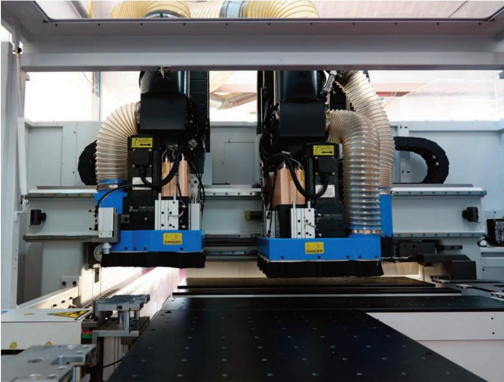
► Auf dem Bild sind die beiden oberen Bohrköpfe zu sehen. Es zeigt, dass beide Köpfe unabhängig voneinander arbeiten können. So wird z.B. die vordere und hintere Lochreihe gleichzeitig gebohrt.
