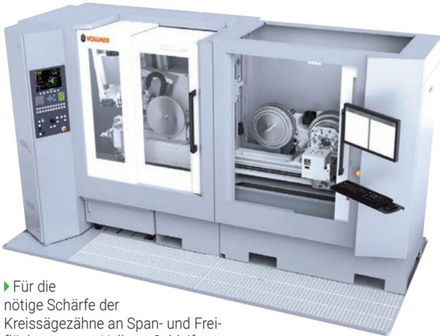
► Für die nötige Schärfe der Kreissägezähne an Span- und Freiflächen sorgen Vollmer Schleifmaschinen wie die CHX 840, CHC 840 oder CHD 270.
