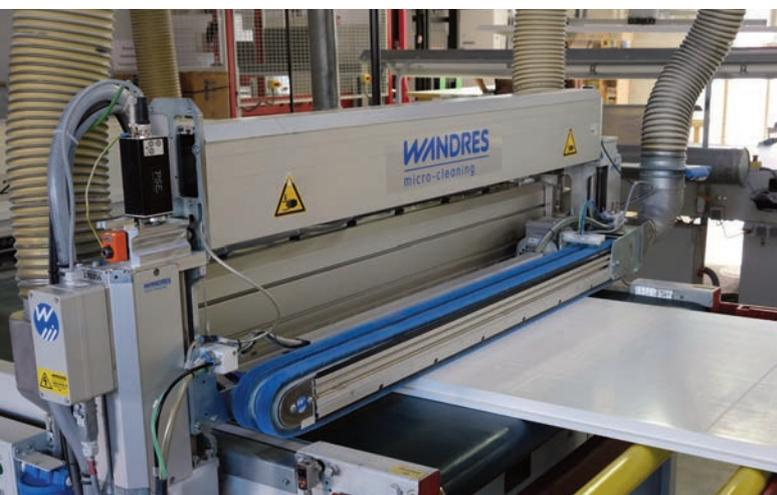
► Die Kombination aus lufttechnischer Reinigung mit dem Tornado-Channel gefolgt von der wischtechnischen Reinigung mit einer Power-Schwertbürste schafft nach dem Lackzwischen Schliff die Voraussetzung für brillante lackierte Oberflächen.
