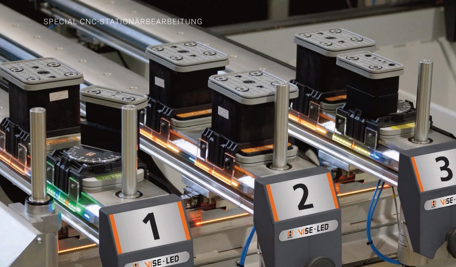
► Der VISE LED-Tisch unterstützt die präzise Saugerpositionierung und Materialausrichtung durch mehrfarbige Lichtbänder – auch bei drehbaren Saugern.
