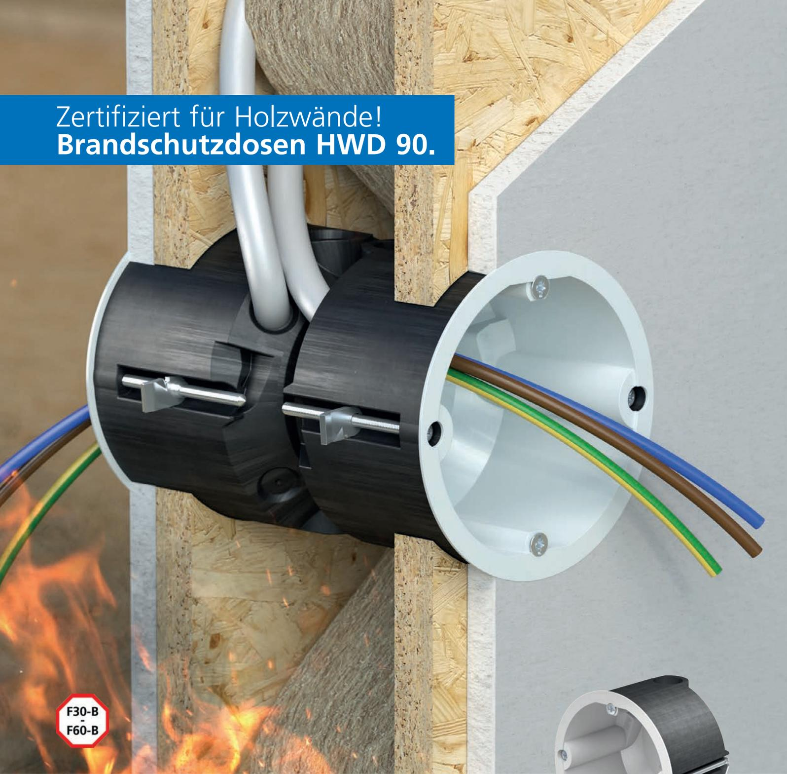
Die KAISER **Brandschutzdosen HWD 90** sind jetzt auch für Holzwände in der Holzrahmen- und Holztafelbauweise zugelassen. Sie erhalten die brandschutztechnische Eigenschaft der Wand mit einer Feuerwiderstandsdauer von F30-B und F60-B aufrecht.
