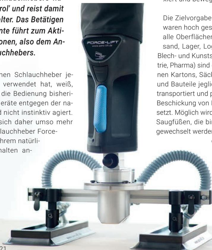
► Der Force-Lift kann schwebend in einer Position verbleiben, mit angesaugtem Transportgut wie auch ohne.
