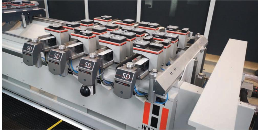
► Mit dem SynchroDrive-Tisch werden alle Konsolen und Vakuumsauger vollautomatisch ausgerichtet.
