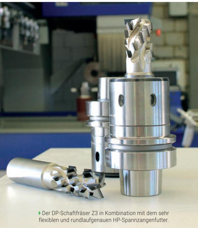
► Der DP-Schaftfräser Z3 in Kombination mit dem sehr flexiblen und rundlaufgenauen HP-Spannzangenfutter.
