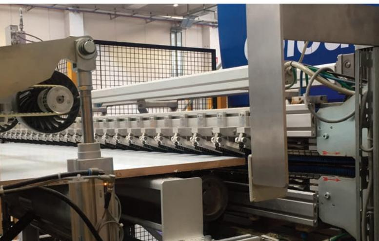
► Die optimale Reinigung von Platten vor der Kamerainspektion verhindert partikelbedingte Falschmeldungen und reduziert somit die Ausschussrate deutlich.
