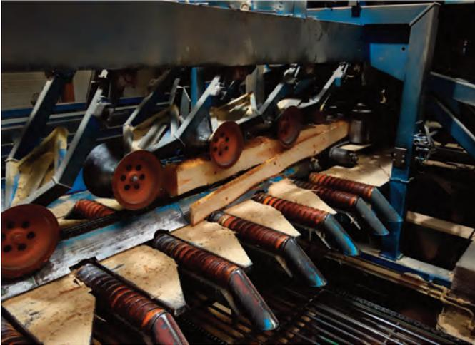
▲ Der Spaner entfernt zwei gegenüberliegende Rundseiten des Stamms; die dafür eingesetzten Schneidwerkzeuge sind in einer Kreismesseraufnahme befestigt.
