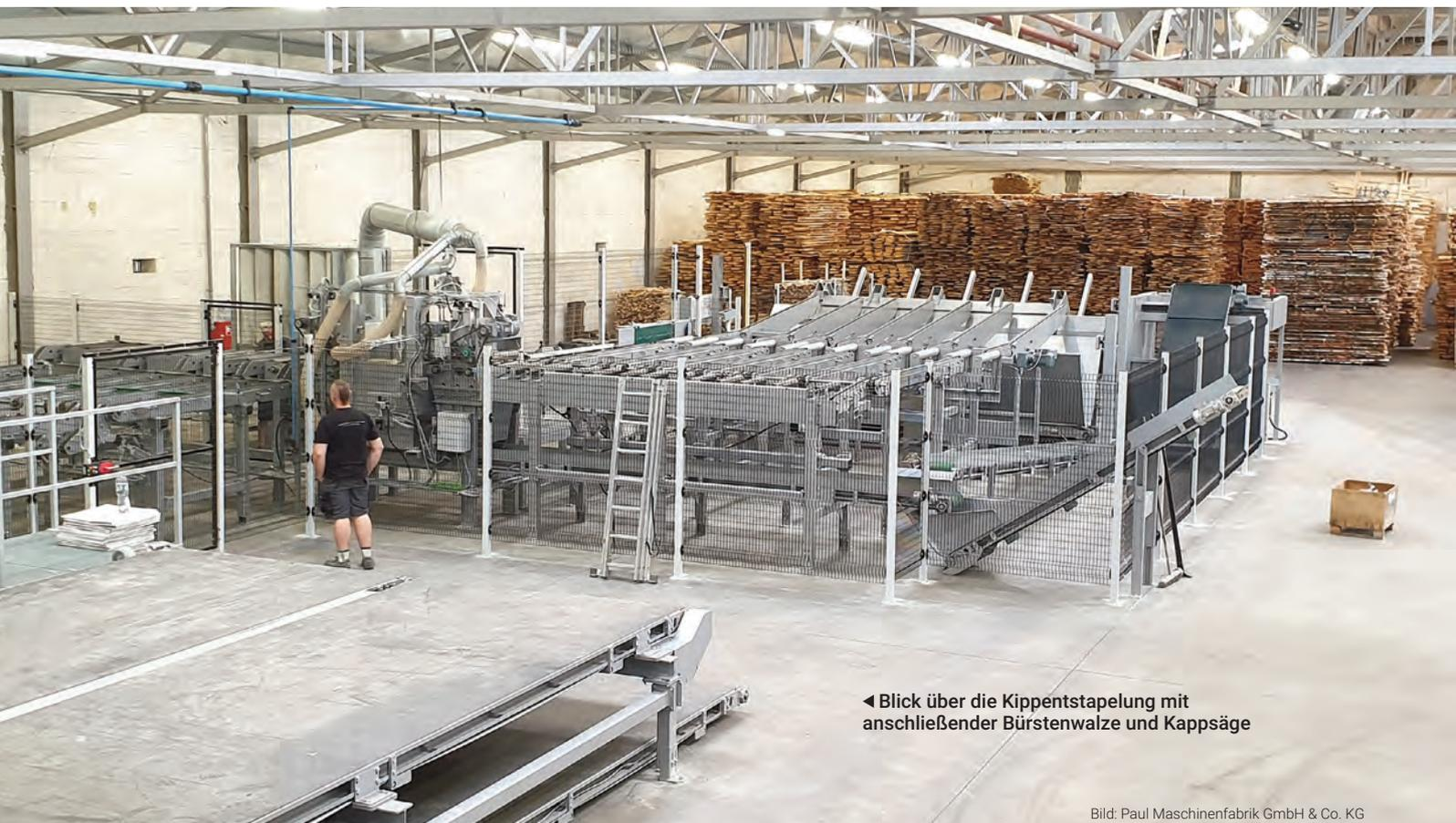
◀ Blick über die Kippentapelung mit anschließender Bürstenwalze und Kappsäge
