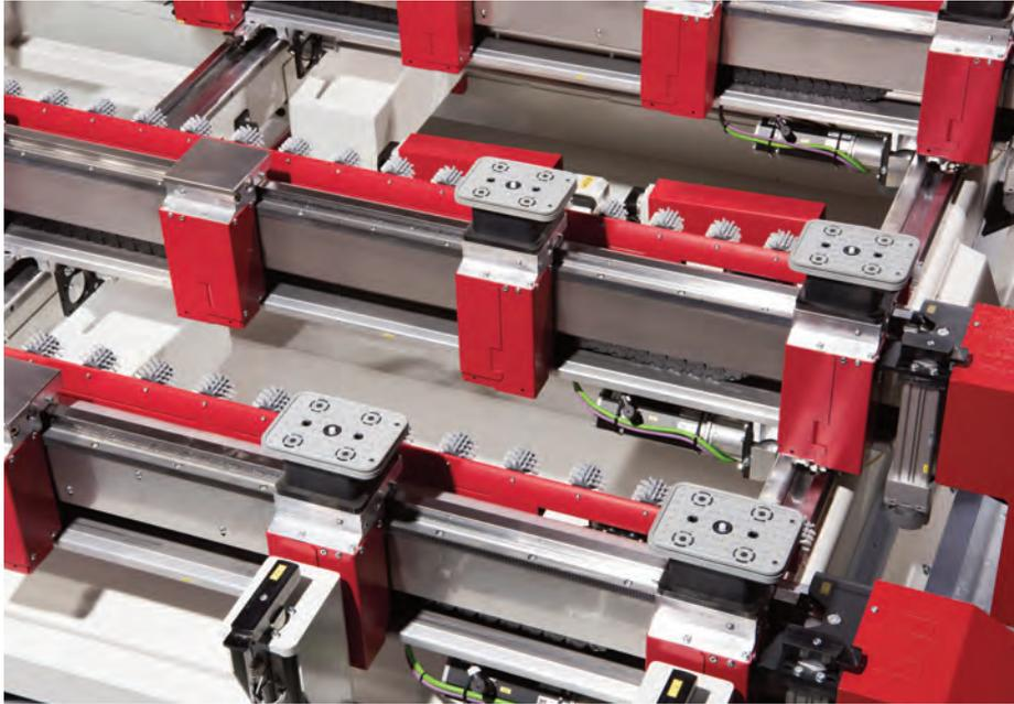
▲ Der Dynapoint-Tisch ermöglicht ein vollautomatisches, präzises Einrüsten innerhalb von Sekunden.
