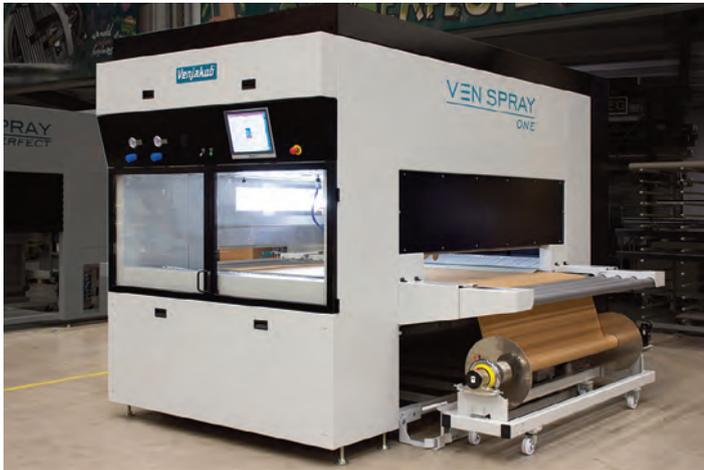
Mit dem Ven Spray One hat Venjakob einen kompakten Lackierautomaten entwickelt, abgestimmt auf die Bedürfnisse von Handwerkern und Kleinbetrieben. Unternehmen, die in kleinen Mengen beschichten, soll damit der Einstieg in die teilautomatisierte Beschichtung gelingen – schnell, einfach und zum attraktiven Preis.
