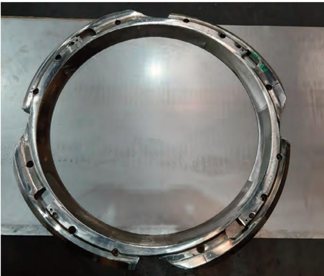
▲ (oben) Per Laserauftragschweißen reparierte Pallas die Verschleißstellen an den Kreismesseraufnahmen.
