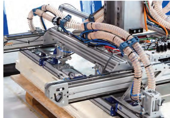
▲ In der Maschine werden die Türen geschliffen, lackiert, getrocknet, etikettiert und sortiert.
