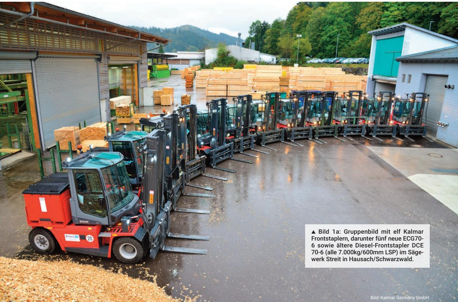
▲ Bild 1a: Gruppenbild mit elf Kalmar Frontstaplern, darunter fünf neue ECG70-6 sowie ältere Diesel-Frontstapler DCE 70-6 (alle 7.000kg/600mm LSP) im Sägewerk Streit in Hausach/Schwarzwald.
