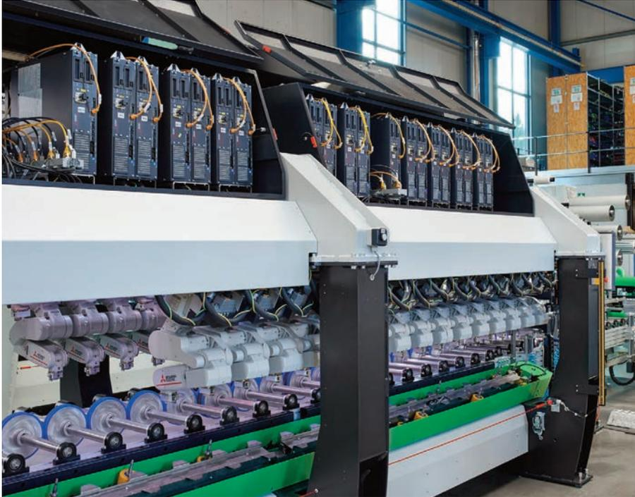
▲ Die neue RoboWrap wurde mit der FR-Roboter- generation und leistungsfähigeren Controllern bestückt.
