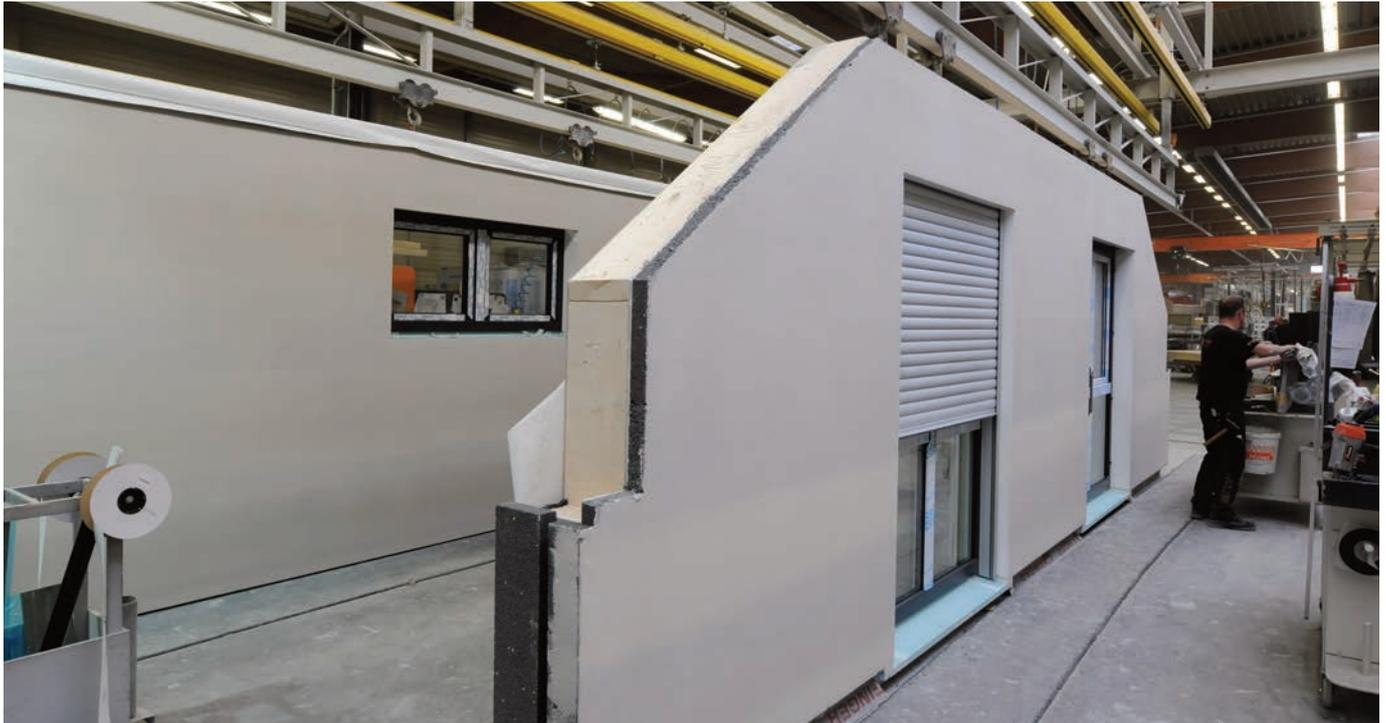
▲ Fertighäuser von FingerHaus bestehen aus komplett vorkonfektionierten Wandelementen, die auf der Baustelle zu einem modernen Haus zusammengesetzt werden.
