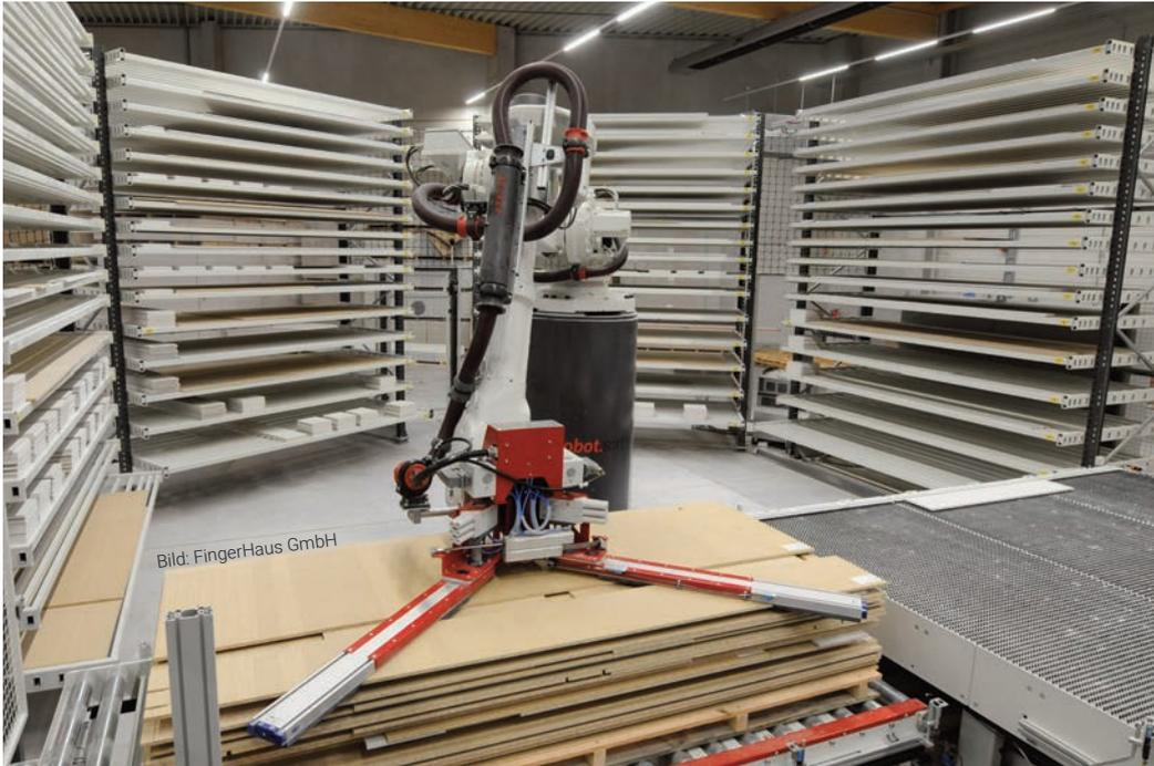
◀ Der mit einem speziellen Vakuumgreifer ausgestattete Roboter lagert die zugeschnittenen Teile in Regalen zwischen und stapelt sie anschließend in der Reihenfolge der Weiterverarbeitung auf Paletten.
