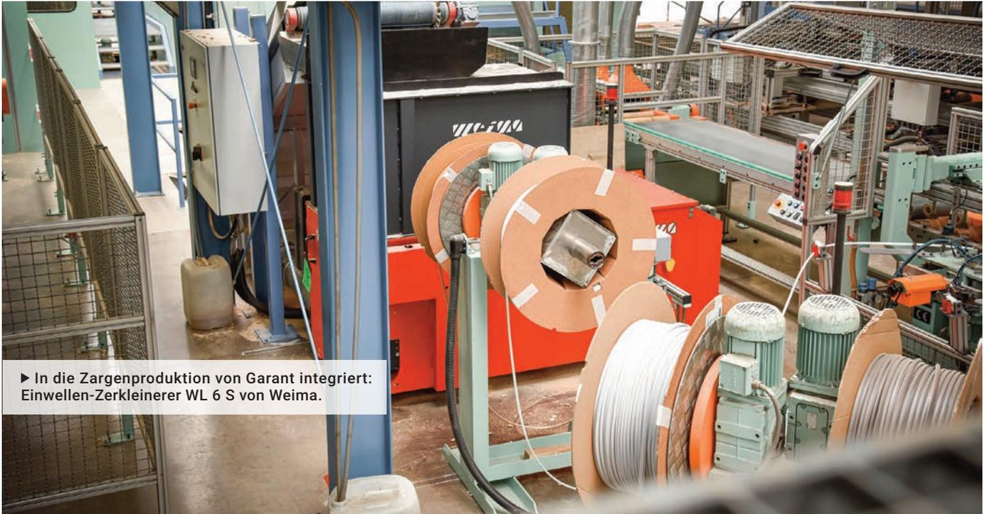
► In die Zargenproduktion von Garant integriert: Einwellen-Zerkleinerer WL 6 S von Weima.
