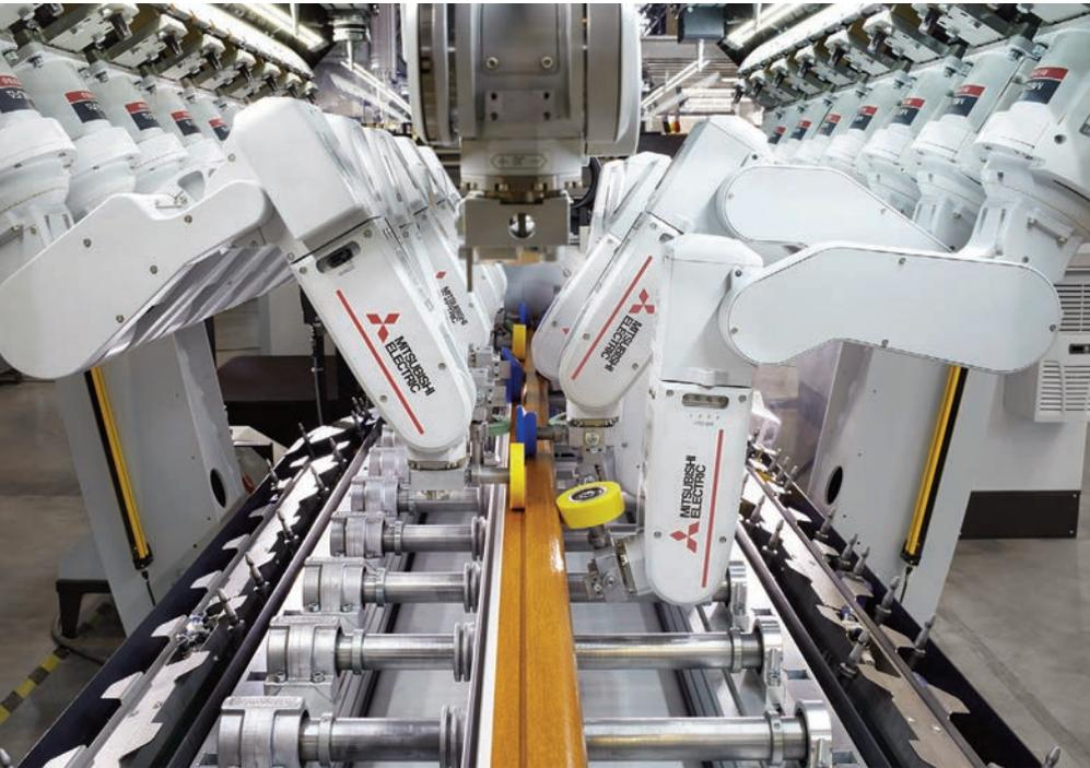
Der Prozess des Profilummantelns dient dem Schutz sowie der Aufwertung, z.B. von Fensterrahmen oder Möbelleisten. Die Profilumrüstung nimmt bei herkömmlichen Maschinen im Durchschnitt eineinhalb Stunden in Anspruch. Das ist zeitaufwendig und erfordert Übung und Erfahrung. Ein Automatisierungskonzept mit 35 Knickarmrobotern oder mehr ist jedoch in der Lage, die Rüstzeiten auf nurmehr fünf Minuten zu verkürzen.
