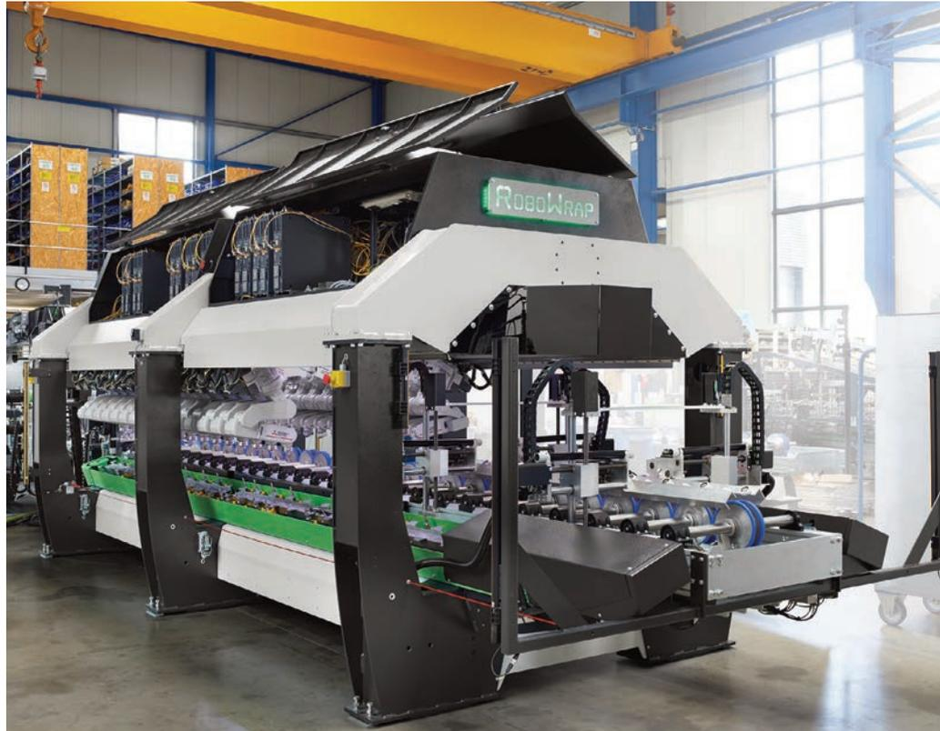
▲ Die RoboWrap ist mit insgesamt 35 Robotern von Mitsubishi Electric ausgestattet – jeweils 15 an den Seiten und fünf oberhalb der Ummantelungszone über Kopf montiert.
