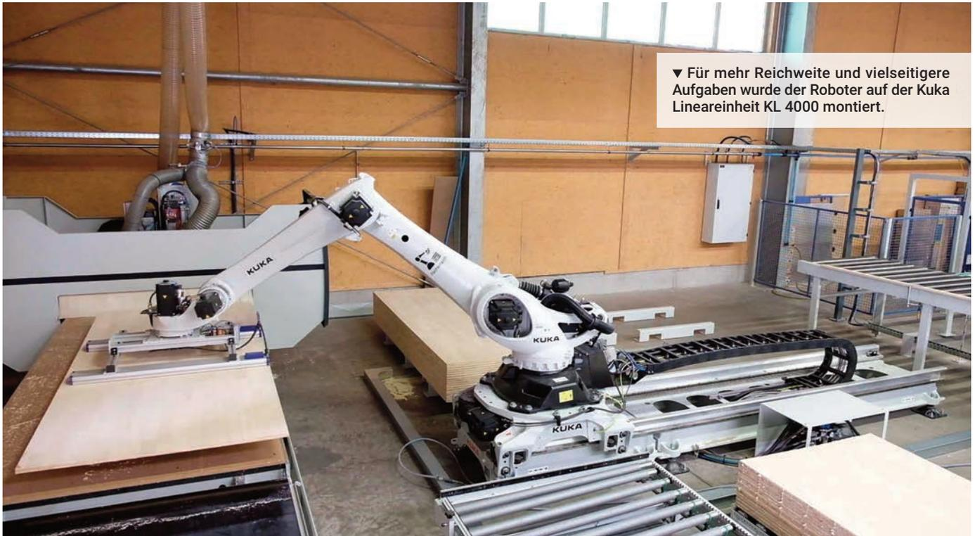
▼ Für mehr Reichweite und vielseitigere Aufgaben wurde der Roboter auf der Kuka Lineareinheit KL 4000 montiert.
