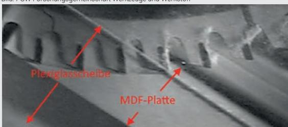
▲ Bild 2: Schnitt durch MDF-Platte mit der Lage der MDF-Platte und der Plexiglasscheibe
