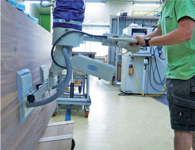
▲ Dank der pneumatischen Schwenkeinheit können die aufrecht stehenden Platten sicher und ergonomisch vom Transportwagen aufgenommen werden.
