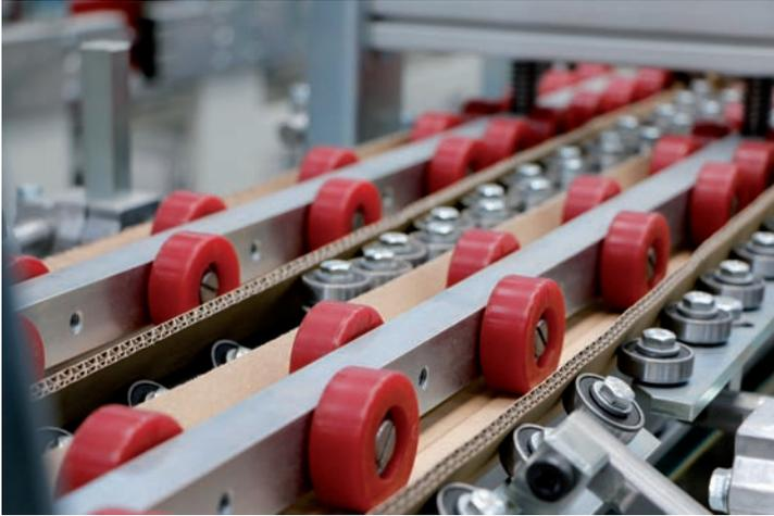
▲ Die Kantenschutzpolster werden endlos gefertigt und mit biologisch abbaubarem Klebstoff fixiert.
