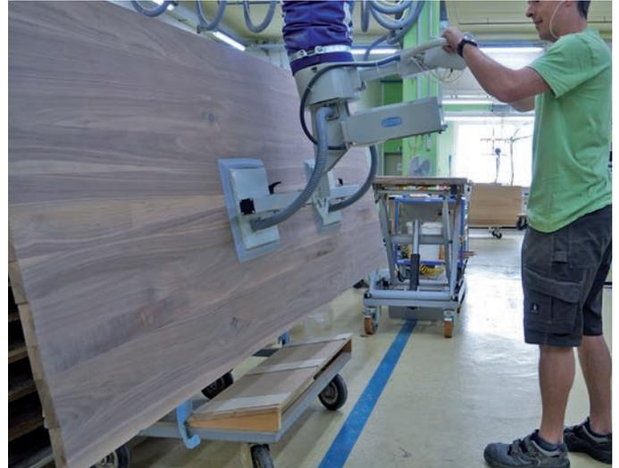
▲ Die pneumatische Schwenkeinheit PSE ermöglicht das Schwenken der großen Platten.
