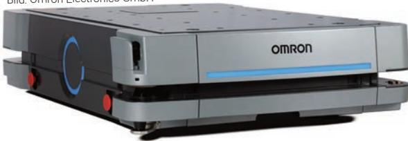
Der HD-1500 berechnet automatisch die beste Route, während er sicher mit Menschen zusammenarbeitet und Hindernissen ausweicht. Auf magnetische Bodenbänder oder andere Wegweiser ist der Roboter dabei nicht angewiesen. In nur 36 Minuten ist der Akku geladen und kann bei Volllast eine komplette Arbeitsschicht bewältigen, wodurch Ausfallzeiten reduziert werden. [www.omron.de](http://www.omron.de)
