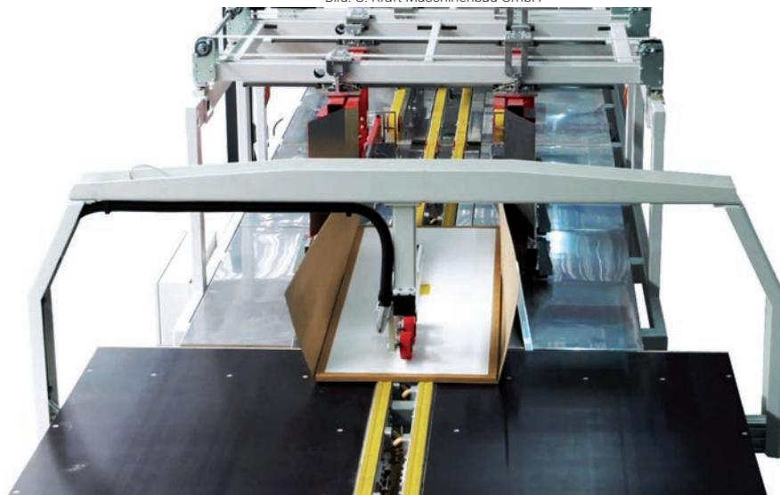
▲ Das Werkstück durchläuft die vollautomatische Faltstation.
