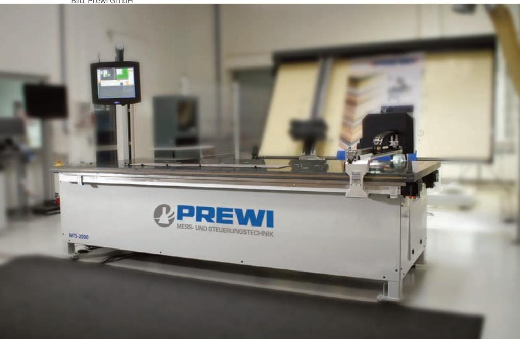
◀ Die neuen MTS-2000 Messtische vermessen plattenförmige Werkstücke, Laminat oder PVC-Paneelen vollautomatisch und berührungslos.
