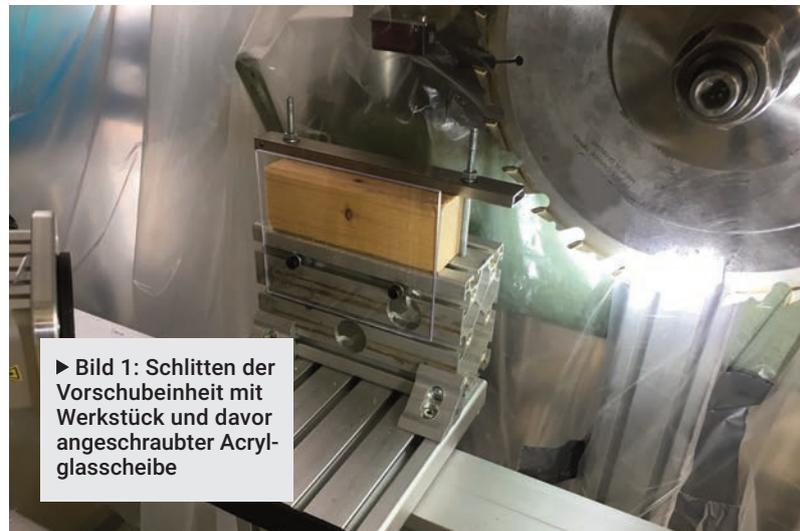
► Bild 1: Schlitten der Vorschubeinheit mit Werkstück und davor angeschraubter Acryl-glasscheibe
