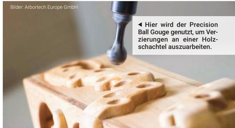
◀ Hier wird der Precision Ball Gouge genutzt, um Verzierungen an einer Holzschachtel auszuarbeiten.
