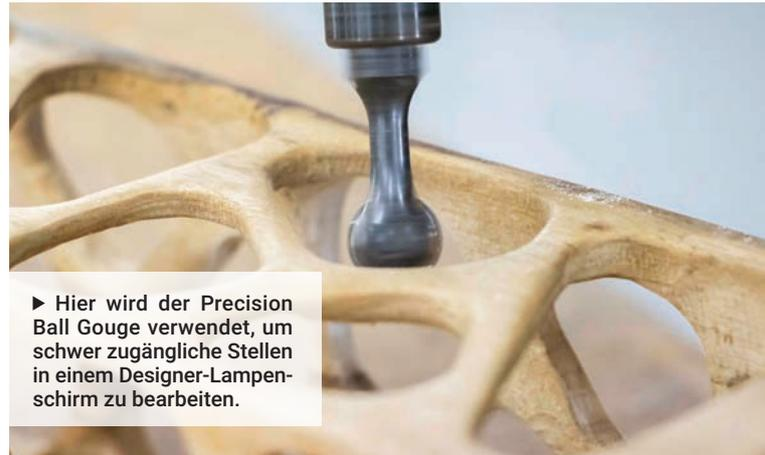
► Hier wird der Precision Ball Gouge verwendet, um schwer zugängliche Stellen in einem Designer-Lampenschirm zu bearbeiten.
